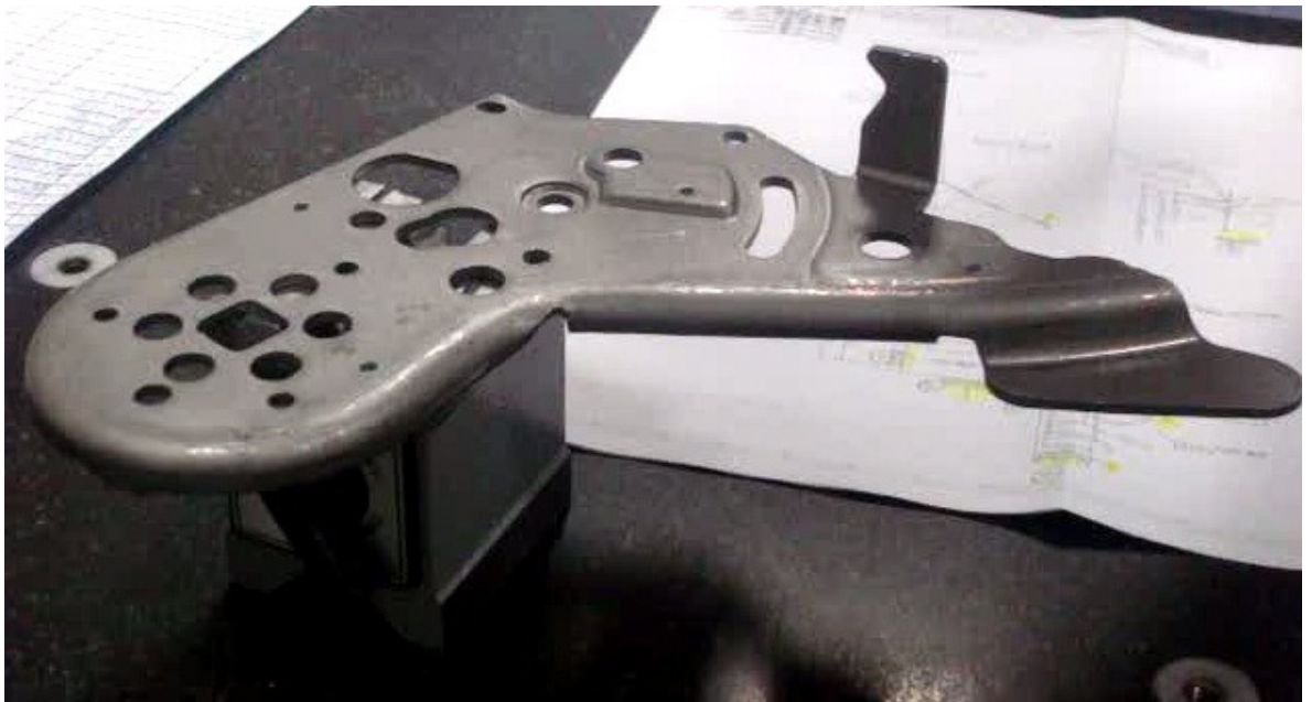
Figura 56 - Fixação da peça 01 para medição no fornecedor
