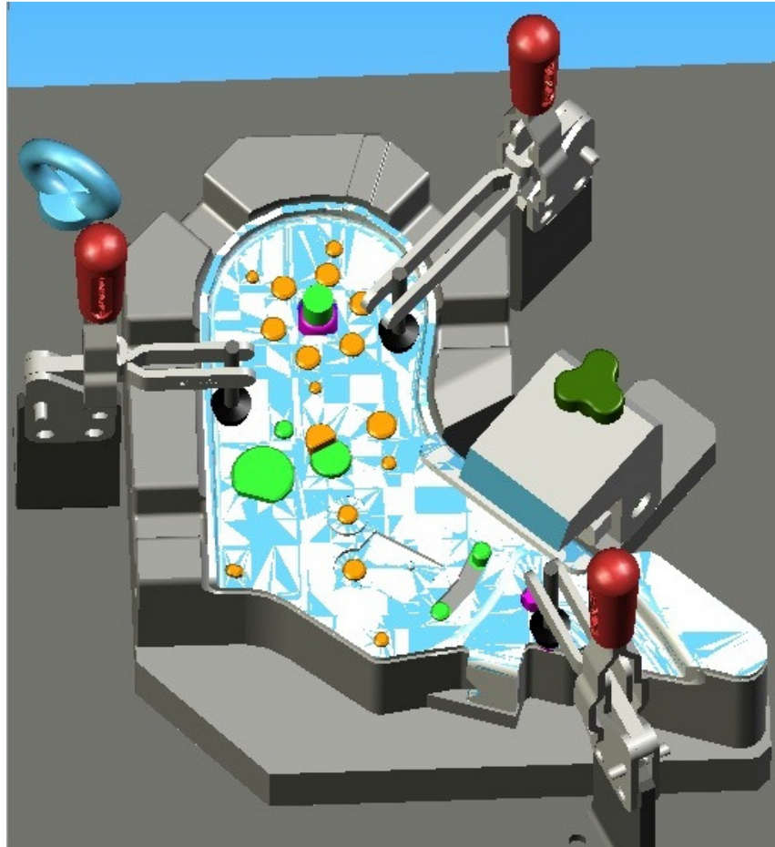
Figura 57- Projeto de um gabarito de controle para a peça 01 (Fonte não autorizada)
