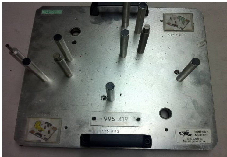
Figura 71 - Foto da base utilizada para apoiar a peça 01 para medição na MMC (Fonte não autorizada)
