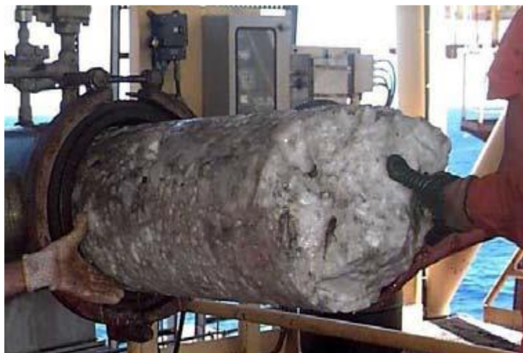
Figura 1.3 – Bloqueio de uma tubulação de extração de petróleo e gás natural por formação de hidratos (Arquivo da Petrobras).
