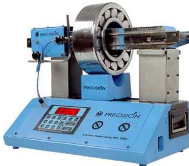
Figura 19: Método de aquecimento por indução.
