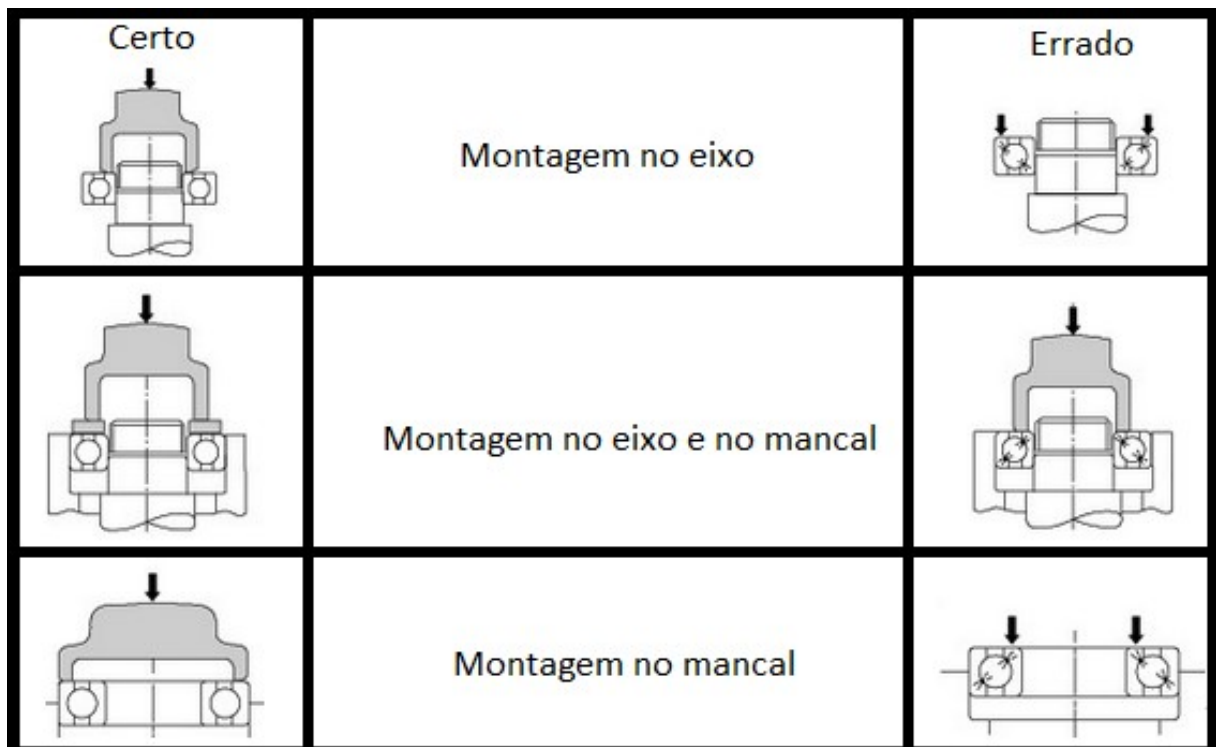
Figura 15: Modo de aplicação de força na montagem de rolamentos.
