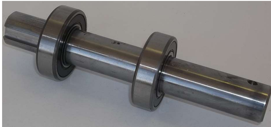
Figura 7: Exemplo de rolamentos acoplados a um eixo.
