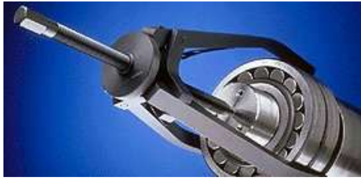
Figura 17: Ferramenta utilizada na desmontagem mecânica de rolamentos.
