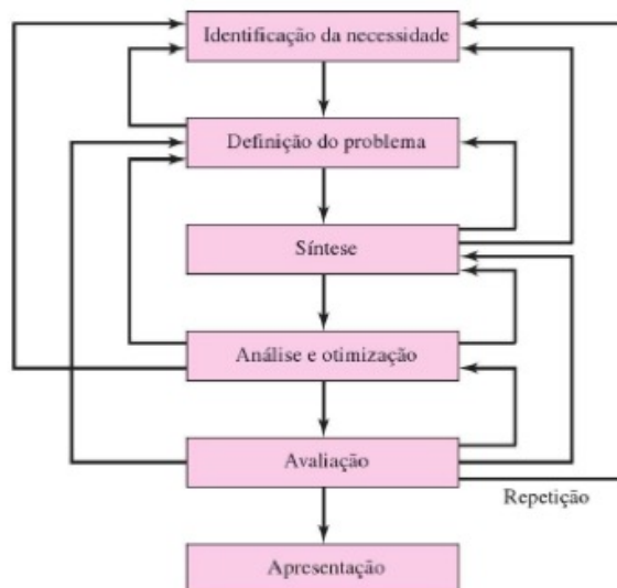
Figura 2.8 – As fases de projeto, identificando as diversas realimentações e repetições.
