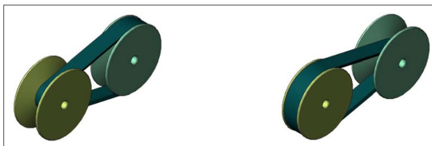
Figura 2.5 – Ilustração do funcionamento de um CVT por polias variadoras. (BIANCHI, 2009)
