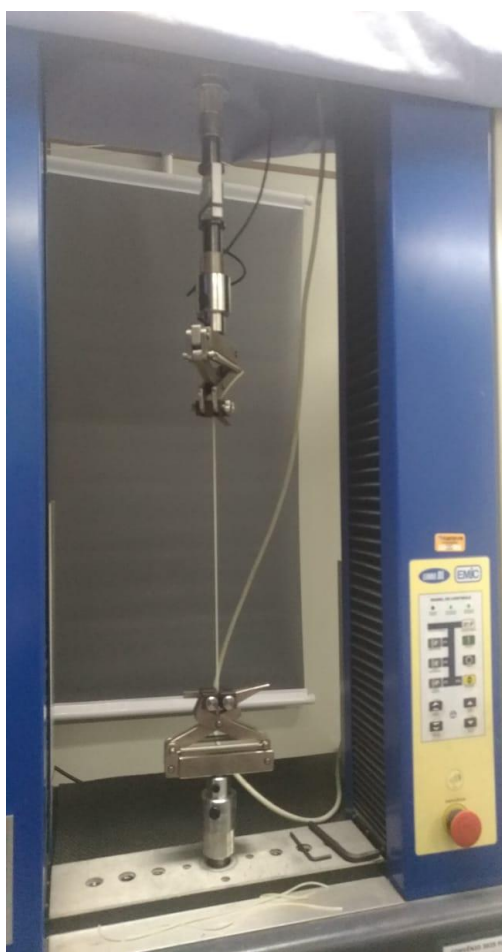
Figura 12 – Ensaio de tração em amostra de monofilamento termoplástico.
