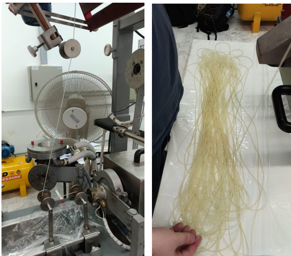
Figura 11 – a) Processo de obtenção do monofilamento na extrusora. b) Exemplo de monofilamento de amido termoplástico.
