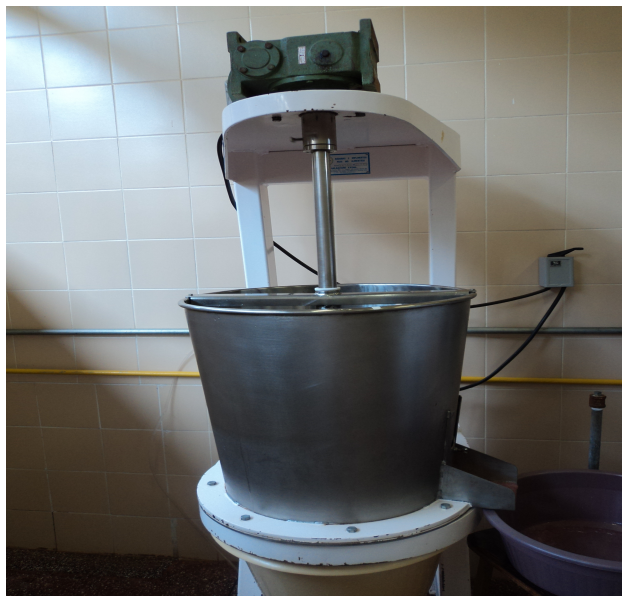
Ilustração 1 – Despolpadeira (Imaçom Ltda. Modelo IM)
