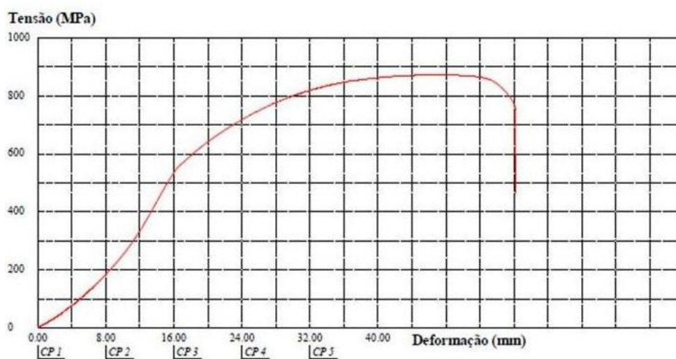
Figura 50: Gráfico Tensão x Deformação-Amostra 6 Fonte: Própria, 2018.
