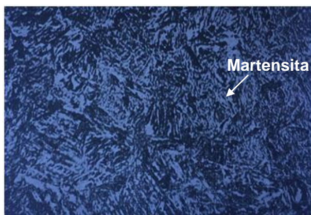
Figura 5: Estrutura martensítica presente em aço carbono temperado e revenido Fonte: Colpaert, 1974.
