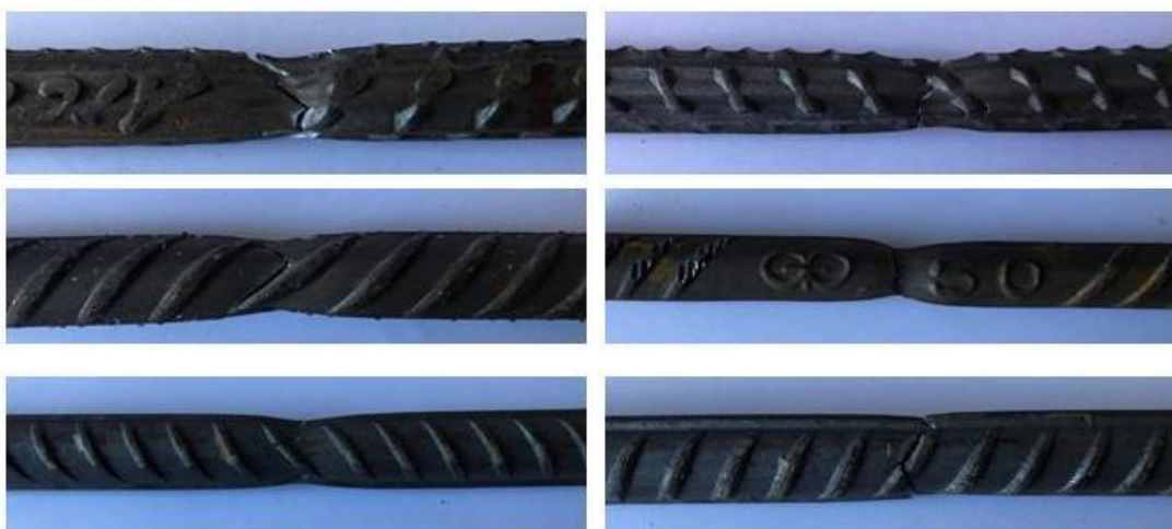
Figura 47: Estricção das amostras Fonte: Própria, 2018.
