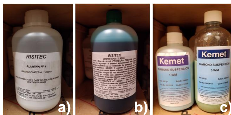
Figura 19: Soluções para polimento: a) Alumina 1 \mu\text{m} ; b) Lubrificante azul; c) Diamante 1 \mu\text{m} e 3 \mu\text{m} Fonte: Própria, 2018.
