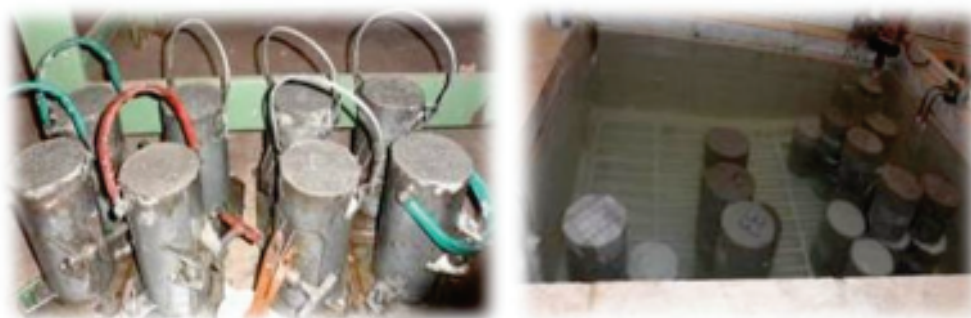
Figura 15 - Moldagem e cura dos corpos de prova
