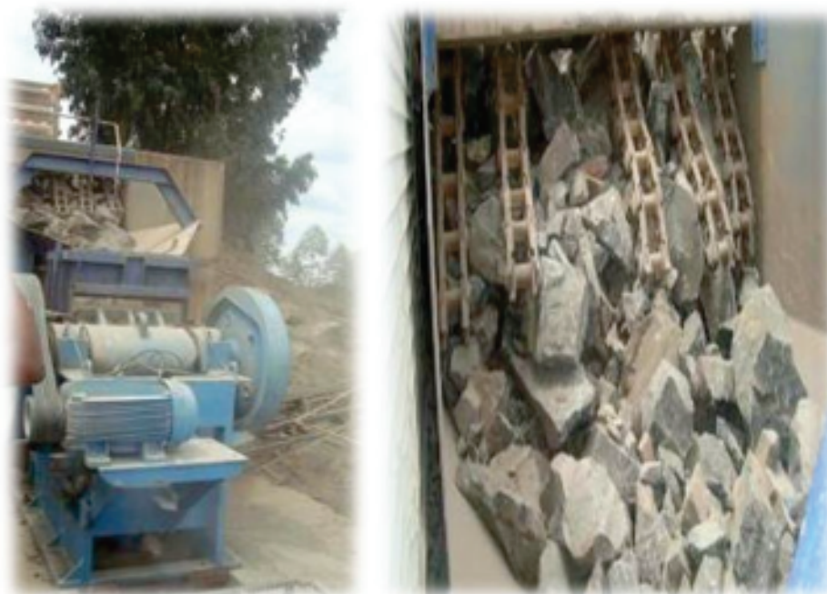
Figura 2 - Vista frontal do britador primário de mandíbulas
