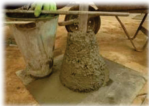
Figura 13 - Abatimento Tronco de Cone – Slump Test
