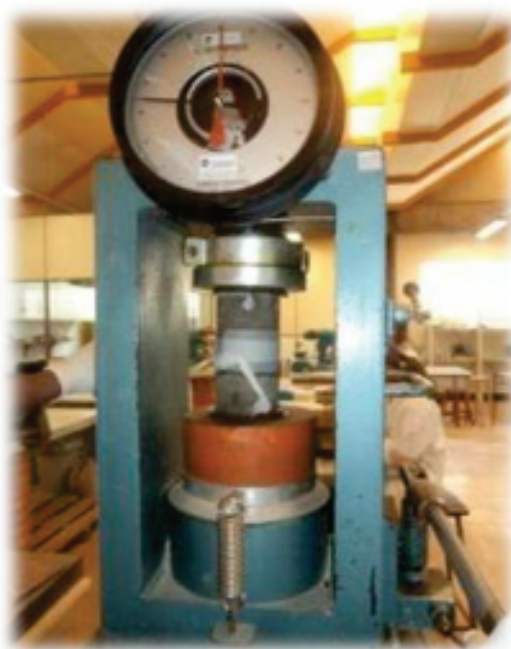
Figura 14 - Ensaio de compressão axial
