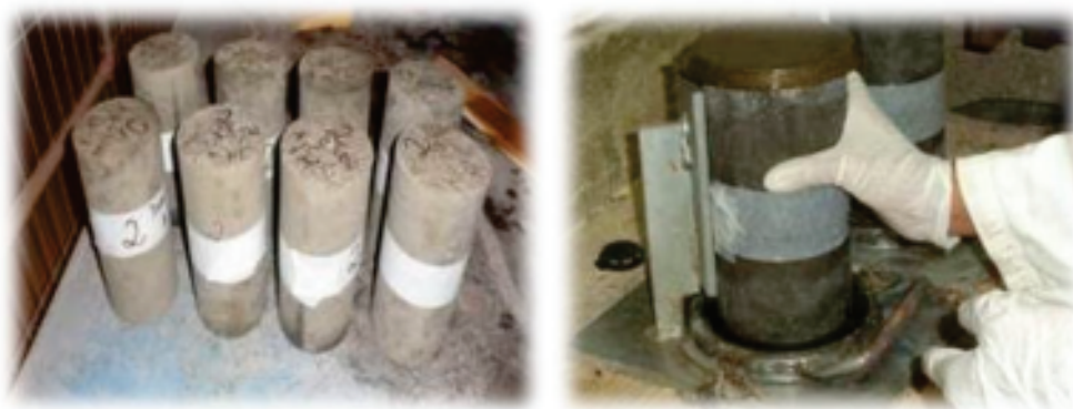
Figura 16 - Capeamento dos corpos de prova
