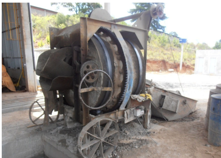
Figura 77 – Misturador para produção de concreto Fonte: O autor, 2013.
