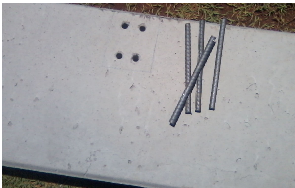
Figura 47 – Peça furada e barras utilizadas para confecção do consolo Fonte: O autor, 2013.
