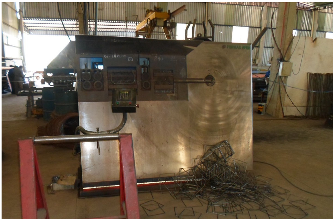
Figura 55 – Máquina de corte e dobra de armaduras (Empresa C) Fonte: O autor, 2013.
