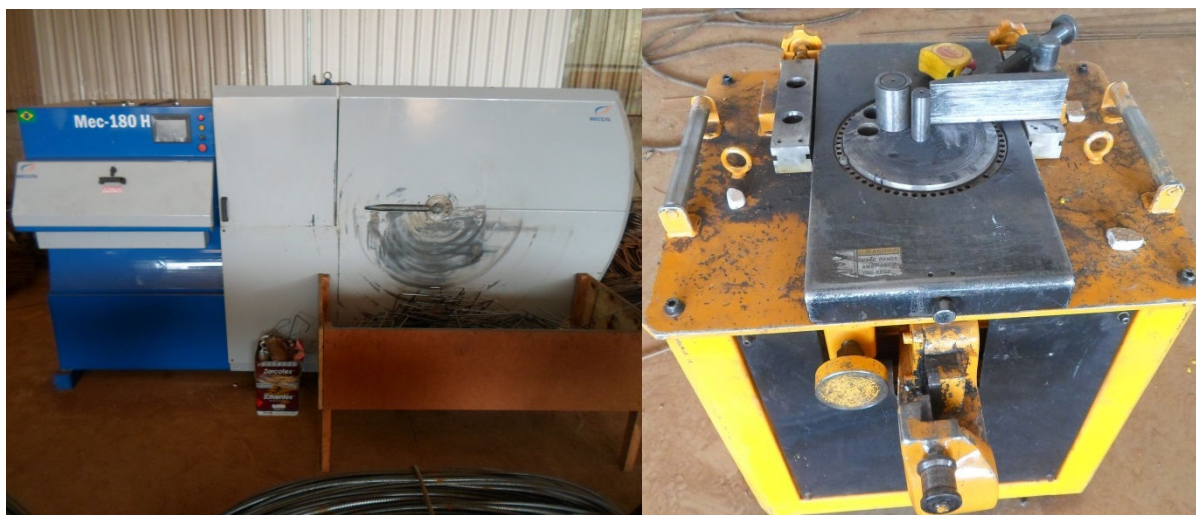
Figura 66 – Máquinas de corte e dobra de aço Fonte: O autor, 2013
