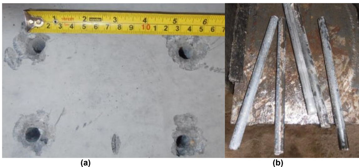
Figura 32 – (a) Furos na peça após retiradas as barras lisas e (b) barras lisas removidas do interior da peça Fonte: O autor, 2013.
