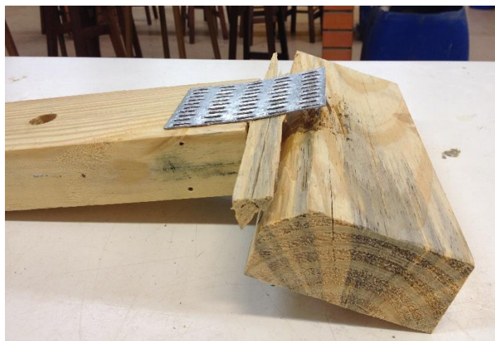
Figura 29 - Ruptura por tração normal as fibras da madeira Fonte: Autoria própria (2015).
