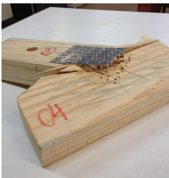
Figura 31 - Ruptura com evidências de rompimento concomitante por tração normal às fibras da madeira e por arrancamento da chapa Fonte: Autoria própria (2015).
