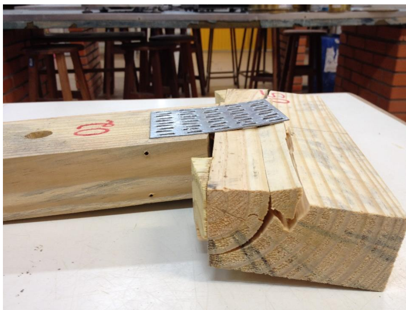
Figura 30 - Ruptura por tração normal as fibras da madeira Fonte: Autoria própria (2015).
