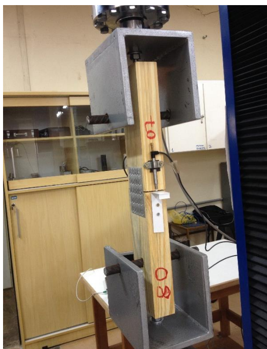
Figura 25 - Dispositivo de ensaio das ligações com \beta=0^\circ Fonte: Autoria própria (2015).
