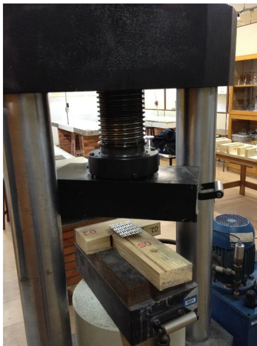
Figura 22 - Prensagem da chapa metálica no corpo de prova Fonte: Autoria própria (2015).
