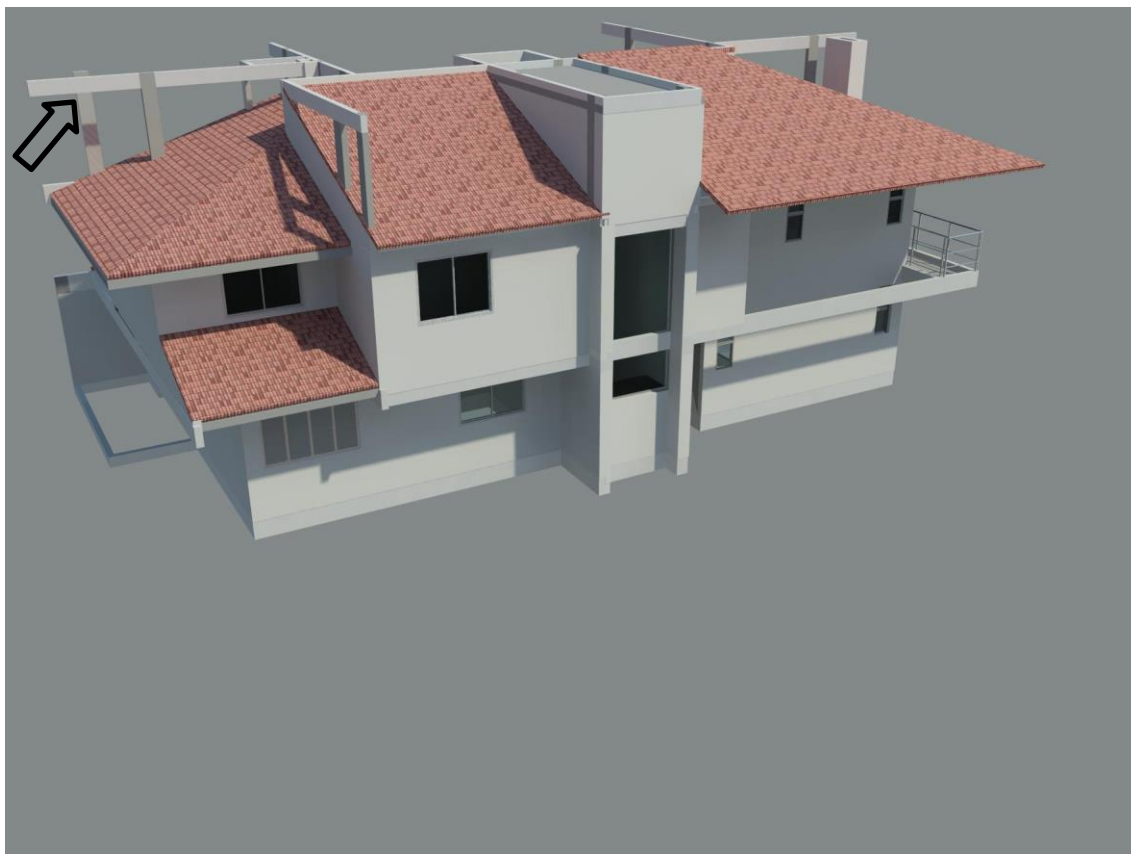
Figura 77: Incompatibilidade de projeto estrutural suposto platibandas
