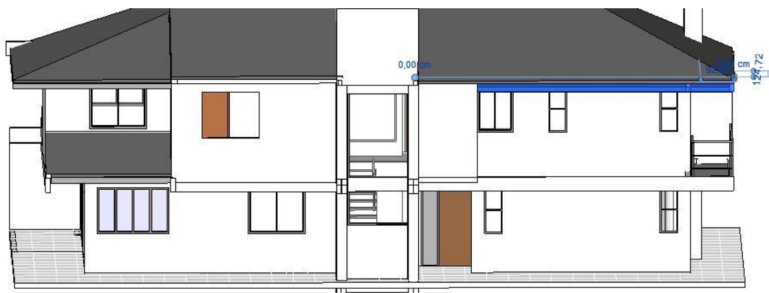
Figura 58: Telhado com 100cm de beiral Fonte: Autoria Própria (2015).
