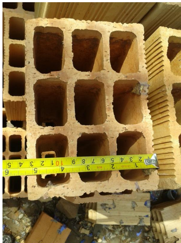
Figura 73: Bloco cerâmico utilizado em obra Fonte: Autoria Própria (2015).
