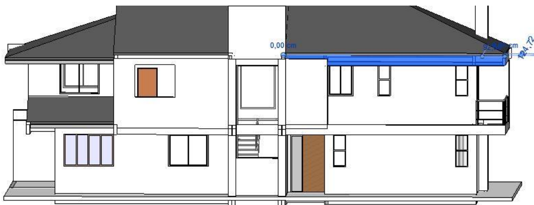
Figura 57: Demonstração da viga V17 conflitando com o telhado proposto de beiral com 45cm Fonte: Autoria Própria (2015).
