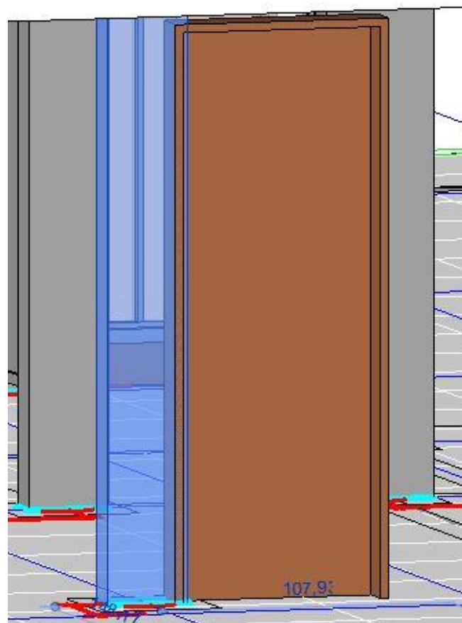
Figura 53: Conflito do Pilar P11 com a porta P3, em vista Fonte: Autoria Própria.
