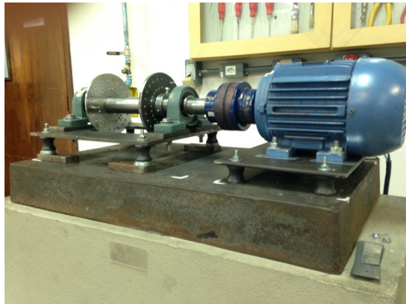
Figura 31 - Bancada com base de coxins
