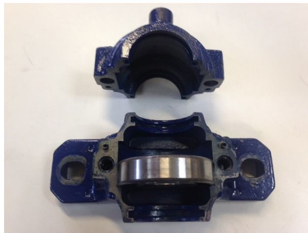
Figura 28 - Arranjo original de mancal e rolamento
