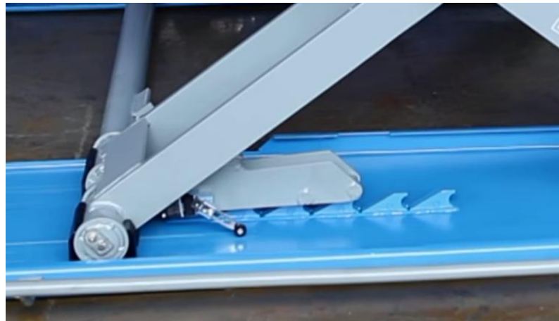
Figura 21 - Sistema de segurança acionado pneumaticamente Fonte: Adaptado de YouTube (2014) (34)
