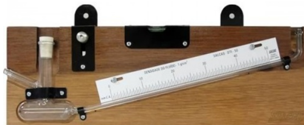
Figura 7 – Manômetro de coluna inclinada Sistema Krell
