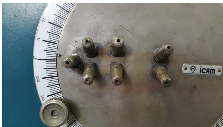
Figura 11 – Saídas para o manômetro dos orifícios de tomada de pressão do Clark-Y
