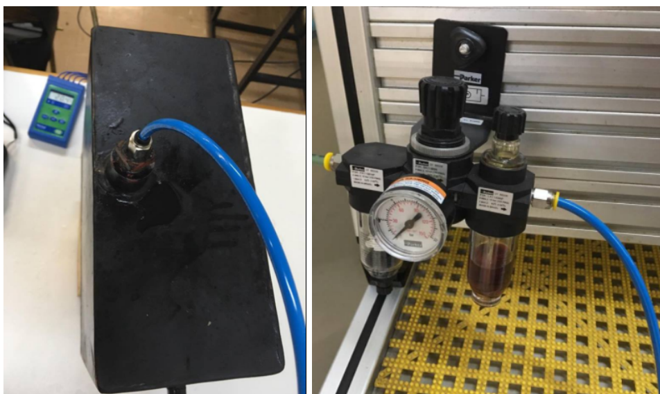
Figura 38 – Sistema de armazenamento de água quente e sistema de ar comprimido
