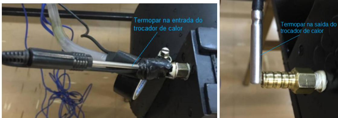
Figura 41 – Termopares instalados na entrada e saída do trocador de calor
