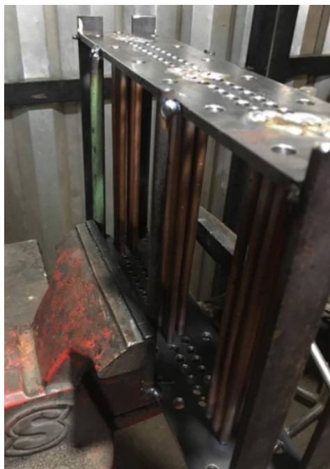
Figura 27 – Canos sendo soldados a estrutura
