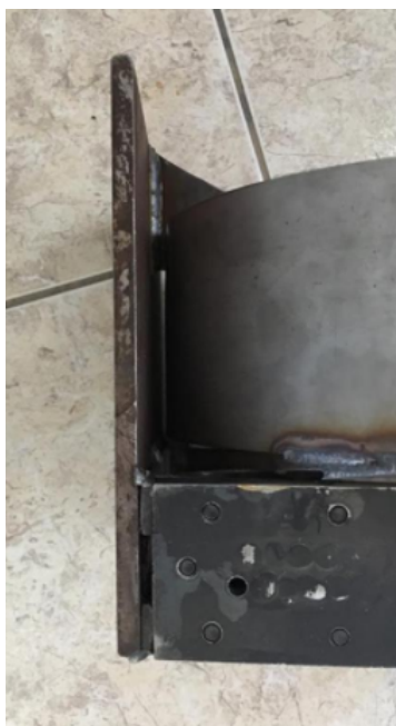
Figura 33 – Base do trocador de calor
