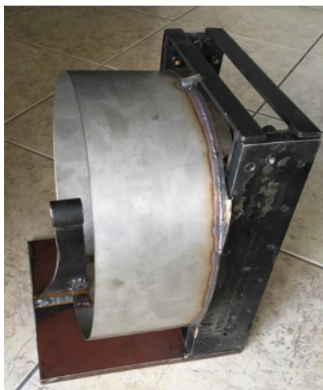
Figura 34 – Proteção da ventoinha
