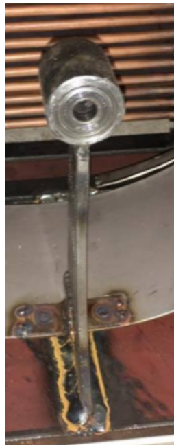
Figura 31 – Mancal da ventoinha do trocador de calor
