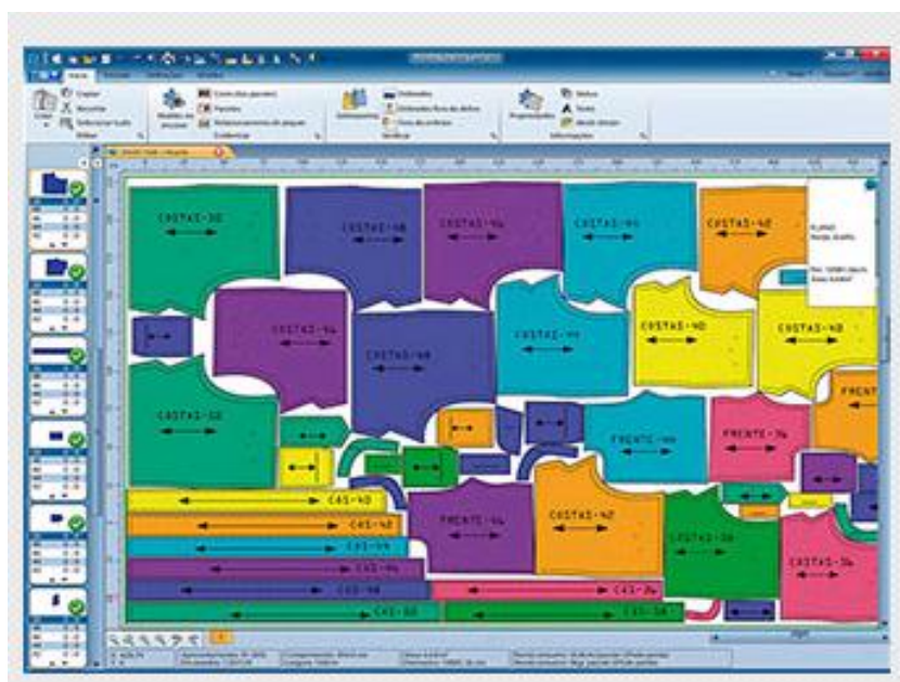
Figura 8 - Modelo de Encaixe de um produto do vestuário Fonte: Audaces (2013)
