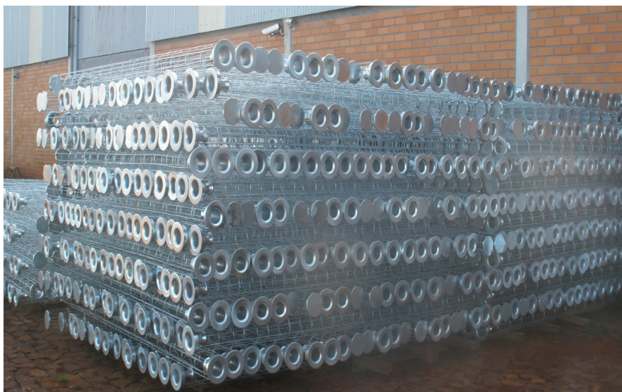
Figura 12 - Gaiolas para Mangas Filtrantes
