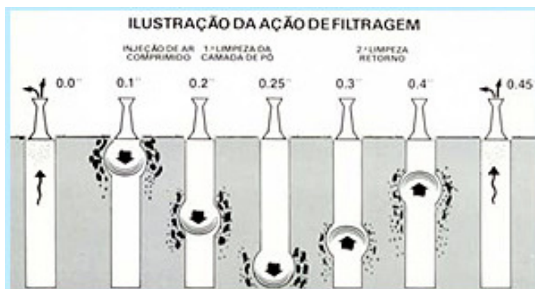
Figura 11 – Exemplo 2 de Limpeza via Ar Comprimido.
