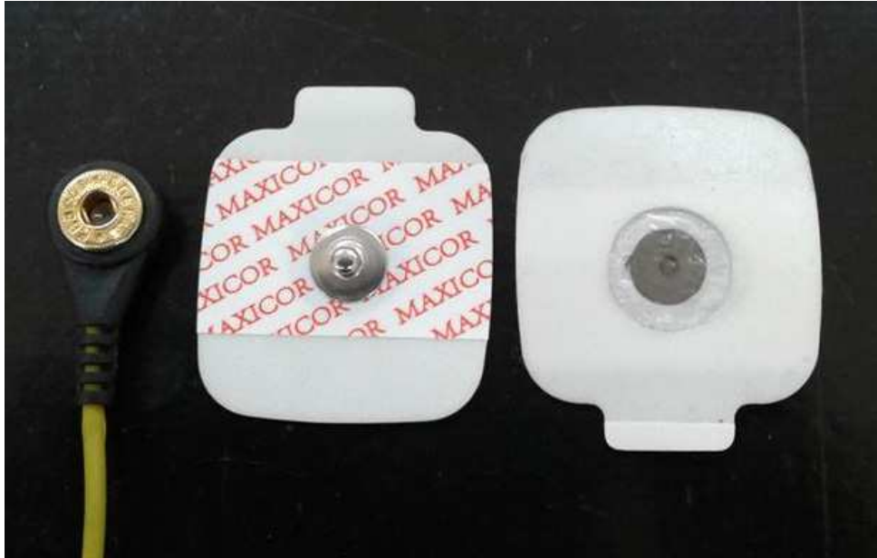
Figura 17: Eletrodo utilizado, explicitando seu pino de encaixe e o conector utilizado no presente trabalho.
