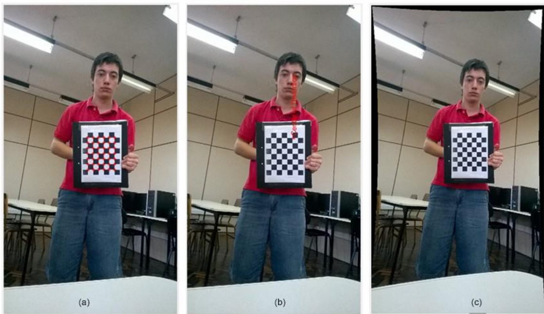
Figura 18 – Ciclo de calibração do Super-Wide-Angle-lens Radial Distortion Toolbox , com (a) detecção do padrão, do (b) centro de distorção e a (c) correção da imagem. Fonte: Autoria própria.
