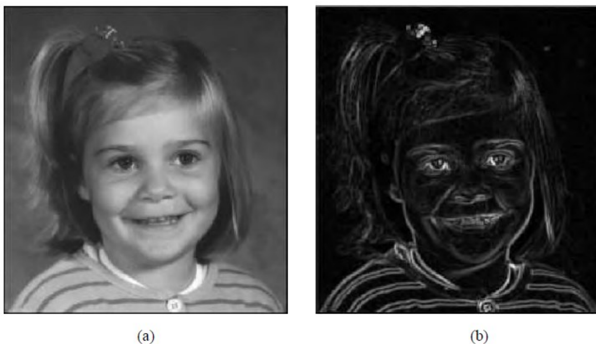
Figura 19 – (a) Imagem original; (b) Gradiente morfológico usando quadrado 3 por 3 como ES. Fonte: (BOVIK, 2009)
