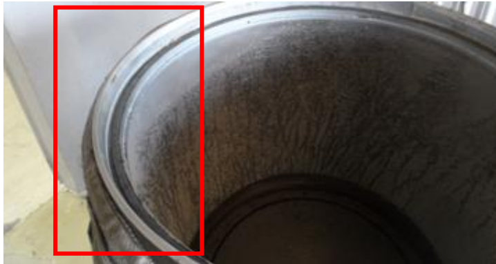
Fig. 24 – Borda do molde se mantém aquecida após resfriamento.
