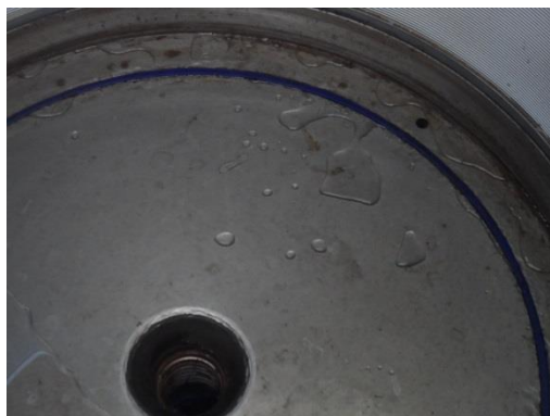
Fig. 23 – Acúmulo de água no fundo do molde.
