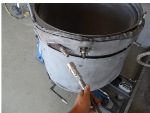
Fig. 14 – Conexão dos engates ao molde.
