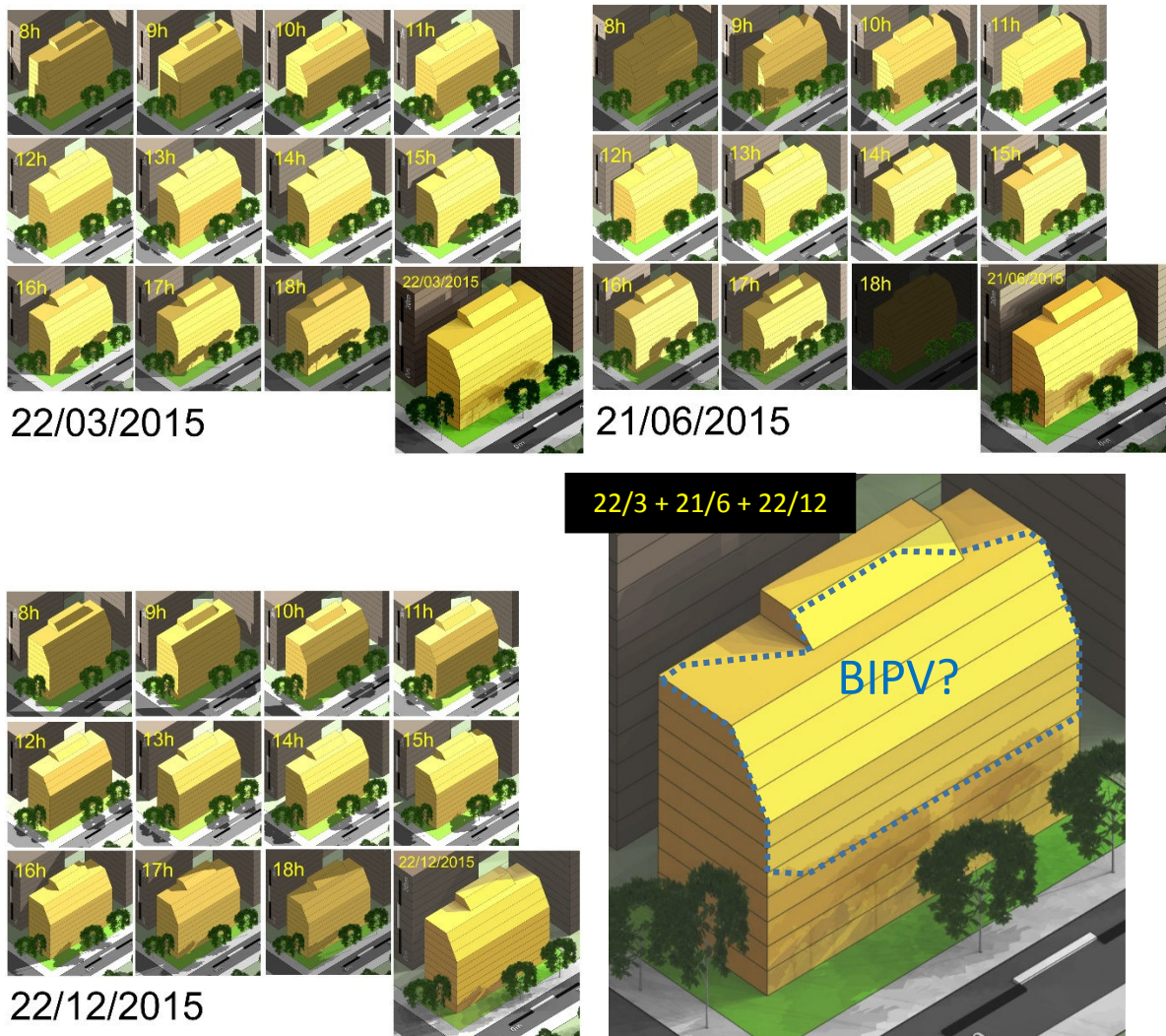
Figura 21: Modelo 3D com ajustes volumétricos propostos. Mascaras de sombra e intensidade da radiação por análise cromática de tonalidade. Softwares utilizados: SketchUp e Corel Photo-Paint. Fonte: Autor.
