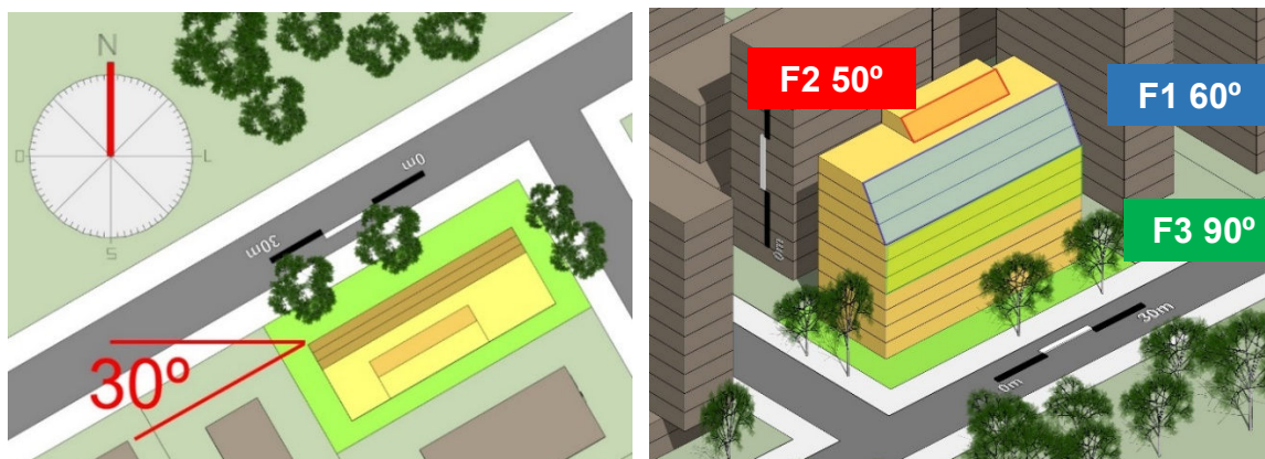
Figura 26: Esquerda: Desenho geométrico da implantação demonstrando desvio azimutal previsto no projeto. Direita: Visualização tridimensional do modelo indicando Faces ativas definidas para o projeto.
