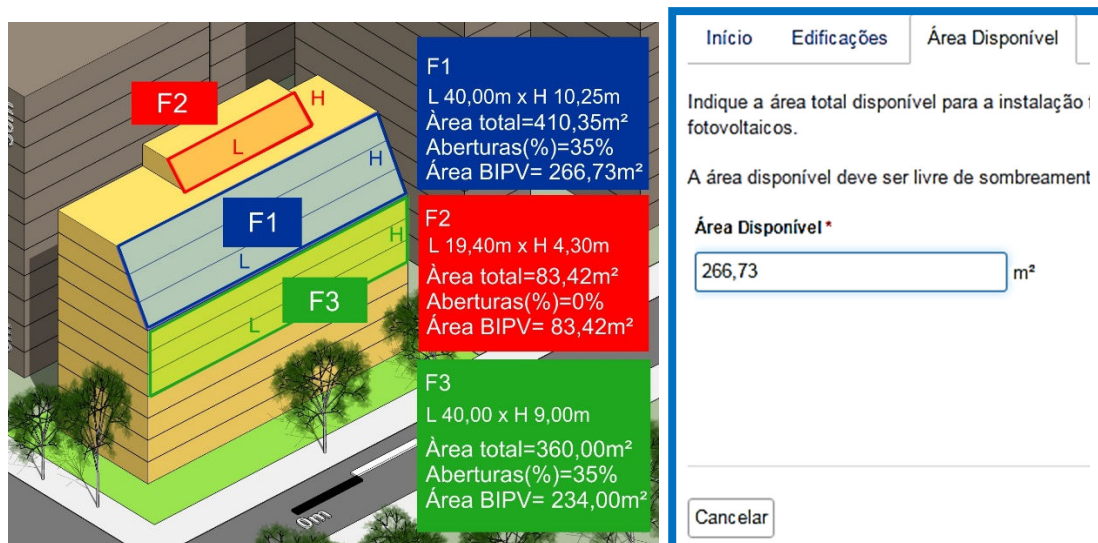
Figura 28: Faces selecionadas para aplicação de painéis fotovoltaicos campo para inserção da área disponível, inserindo-se dados para F1.
