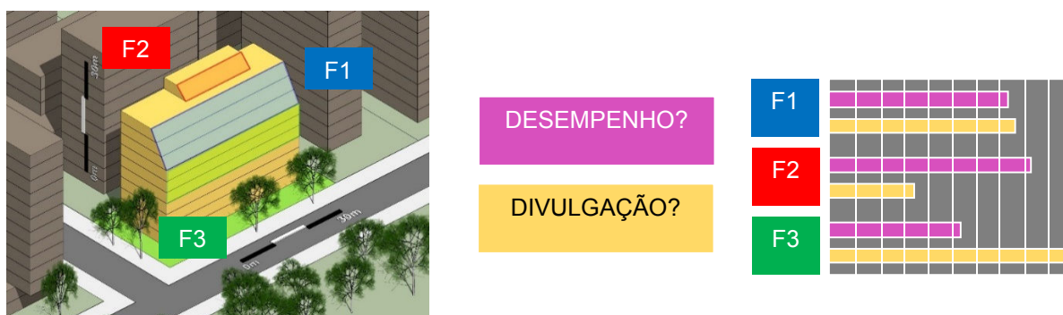
Figura 22: Esquerda: Definição das faces que poderão receber o material fotovoltaico. Direita: O potencial percebido conforme análise desempenho e divulgação.
