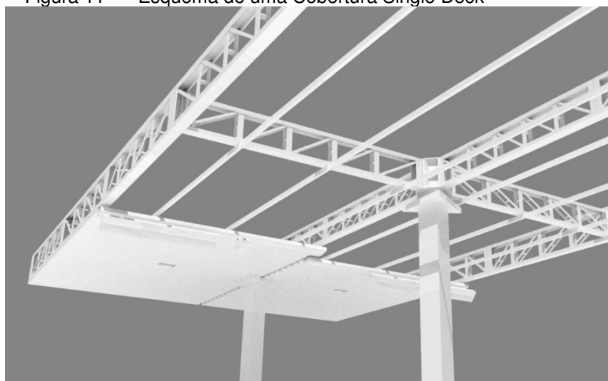
Figura 11 - Esquema de uma Cobertura Single Deck
