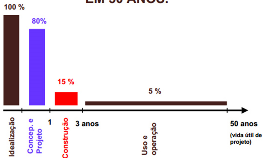
Figura 6: Possibilidade de interferência no custo total de um edifício em 50 anos. Fonte: CEOTTO (2006).
