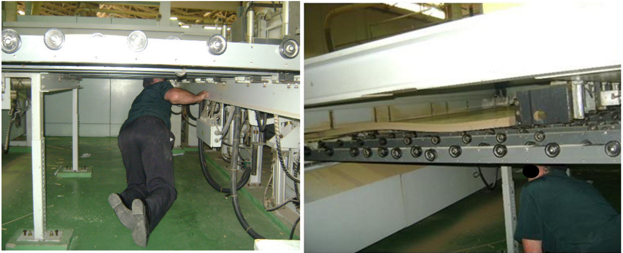
Figura 27 – Ajustes e inspeções com equipamento em movimento.
