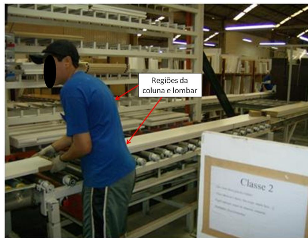
Figura 40 – Trabalhador posicionando peças no setor de embalagem – postura inadequada.
