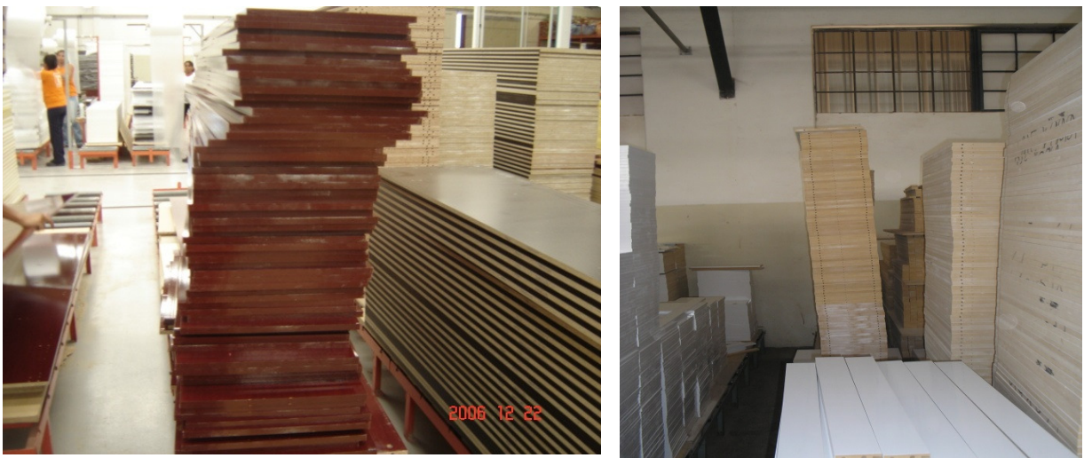
Figura 30 – Pilhas de peças desalinhadas, podendo causar acidentes as pessoas e danos materiais.
