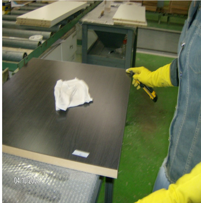
Figura 38 – Uso de objeto cortante com luvas inadequadas para prevenção de corte.
