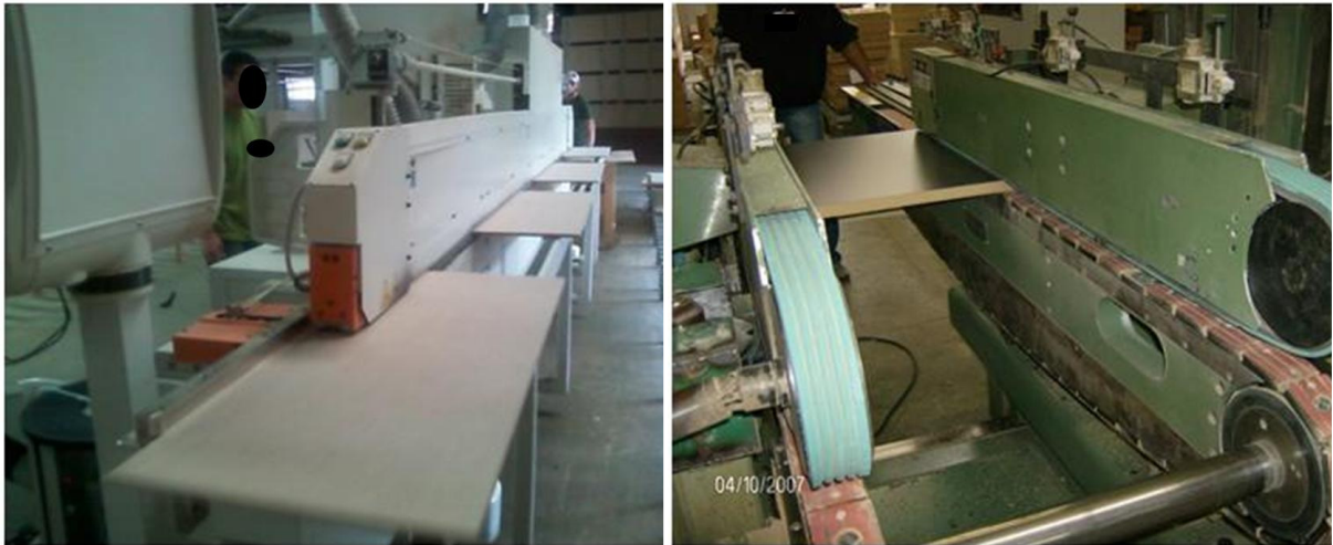
Figura 9 – O operador alimenta as peças na coladeira de bordo.
