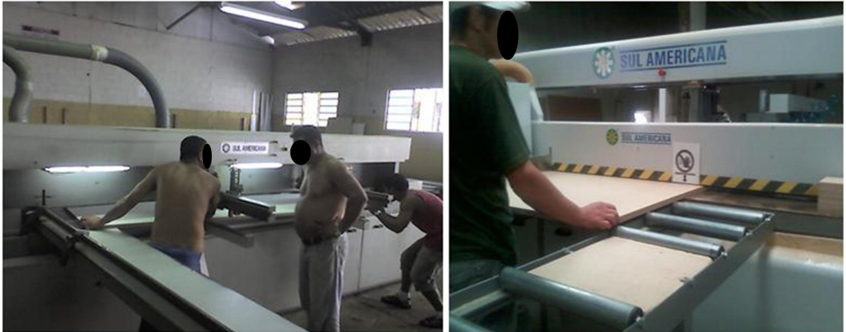
Figura 29 – Operadores da seccionadora sem os EPIs adequados a tarefa.
