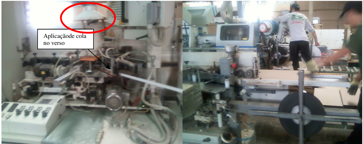
Figura 33 – Operadores da coladeira sem óculos de proteção e luvas
