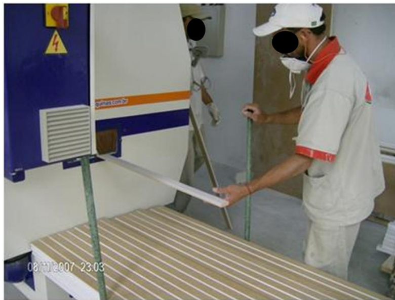
Figura 37 – Pintura UV para ripas, uso inadequado do EPI. Fonte: A autora, (2007).
