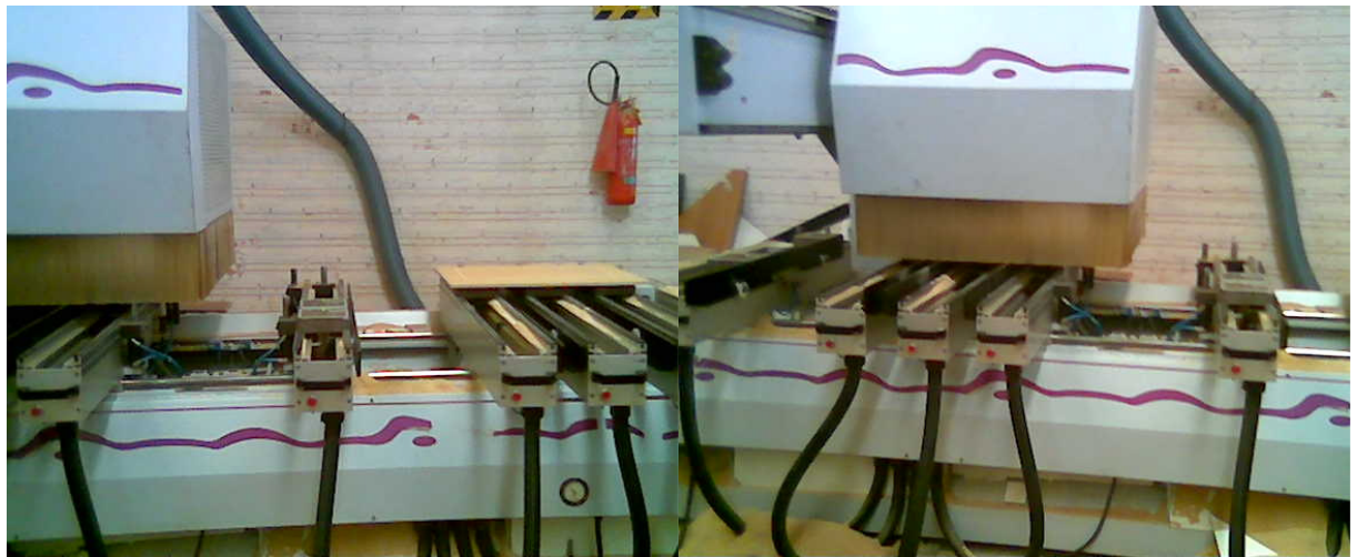
Figura 14 – Centro de usinagem alimentação para duas peças simultaneamente.
