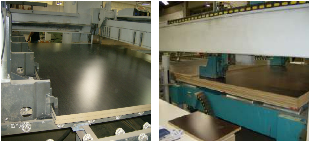
Figura 3 – Alimentação automática da seccionadora.
