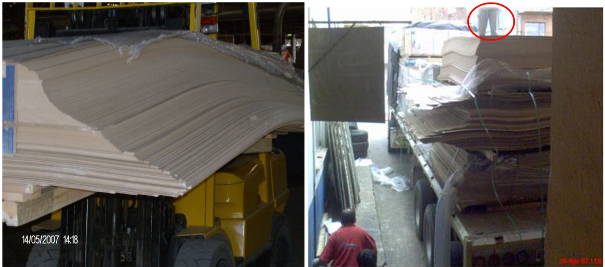
Figura 22 – Embalagem avariada podendo causar tombamento do equipamento e acidentes envolvendo pessoas.
