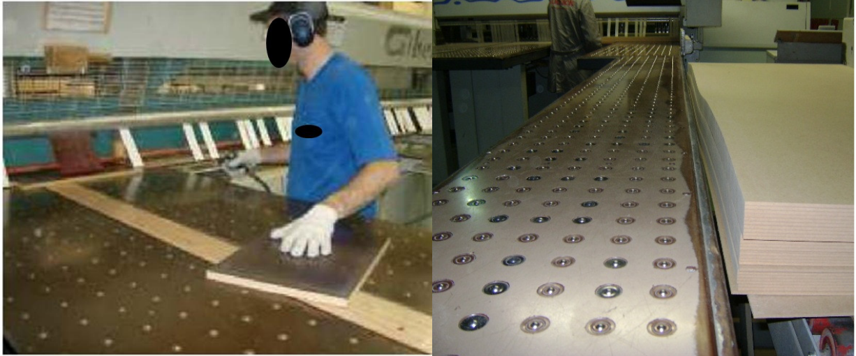
Figura 4 - Manuseio manual das peças cortadas sobre rolinhos com saída de ar.
