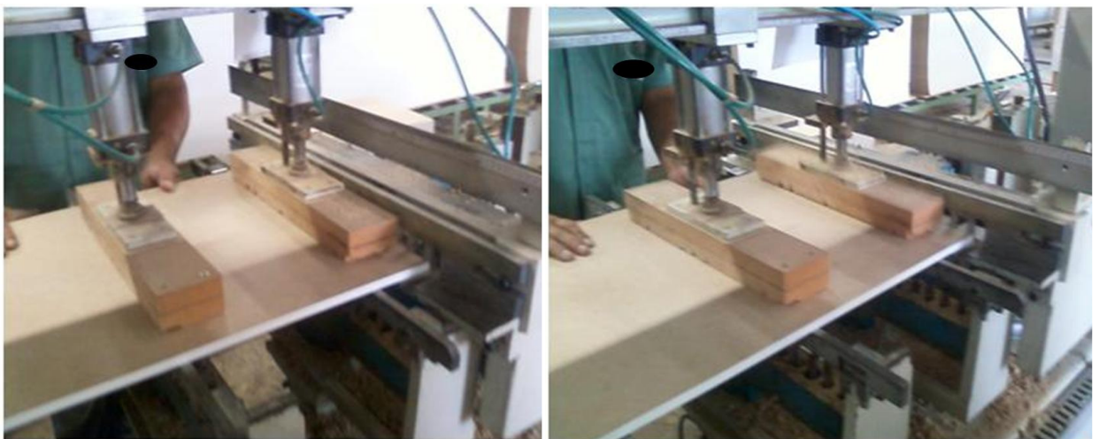
Figura 8 – Furadeira com regulagem e alimentação manual.
