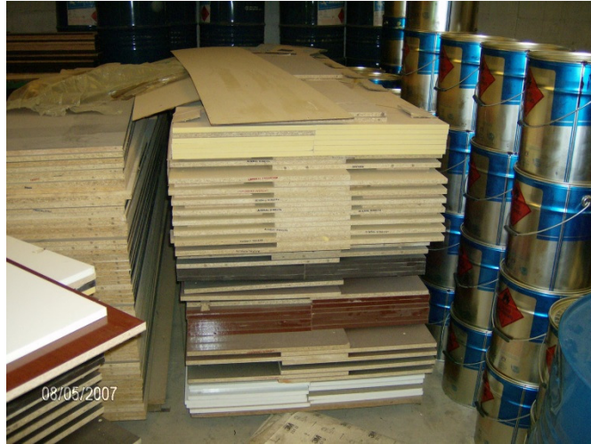
Figura 36 – Armazenagem das peças pintadas próximo às latas de tinta UV. Fonte: A autora, (2007).
