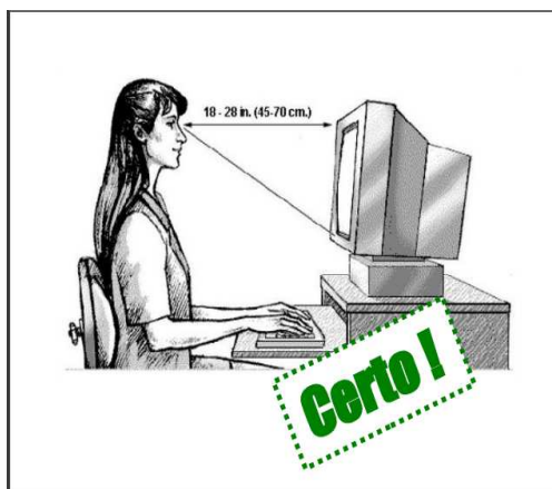
Figura 15 - Postura CORRETA do operador diante do monitor e postura correta de digitação em ângulo de 90º e distância das mãos no teclado. FONTE: Flavius (2007).
