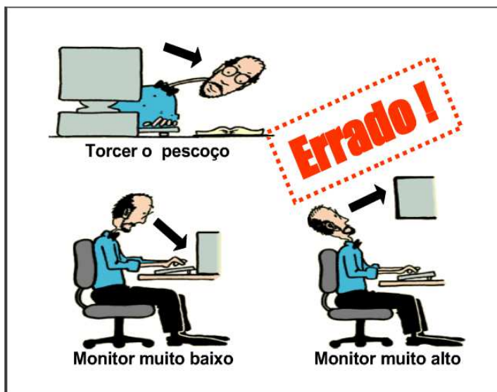
Figura 16 - Diversas posturas INCORRETAS do operador diante do monitor e postura igualmente incorreta de digitação e de distância das mãos no teclado. FONTE: Flavius (2007).
