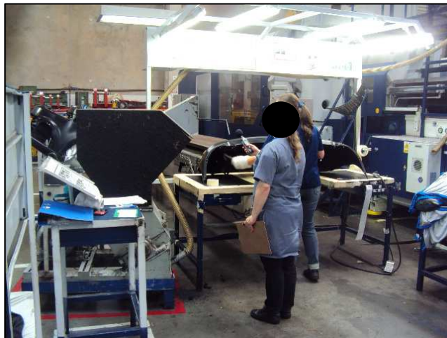
Figura 7: Medição do nível de ruído na injetora 2000 I
