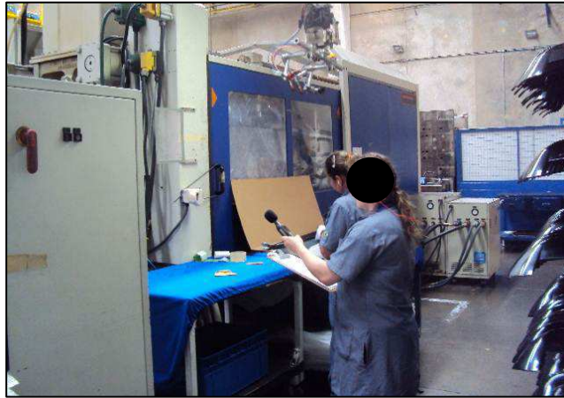
Figura 6: Medição do nível de ruído na injetora 600 II
