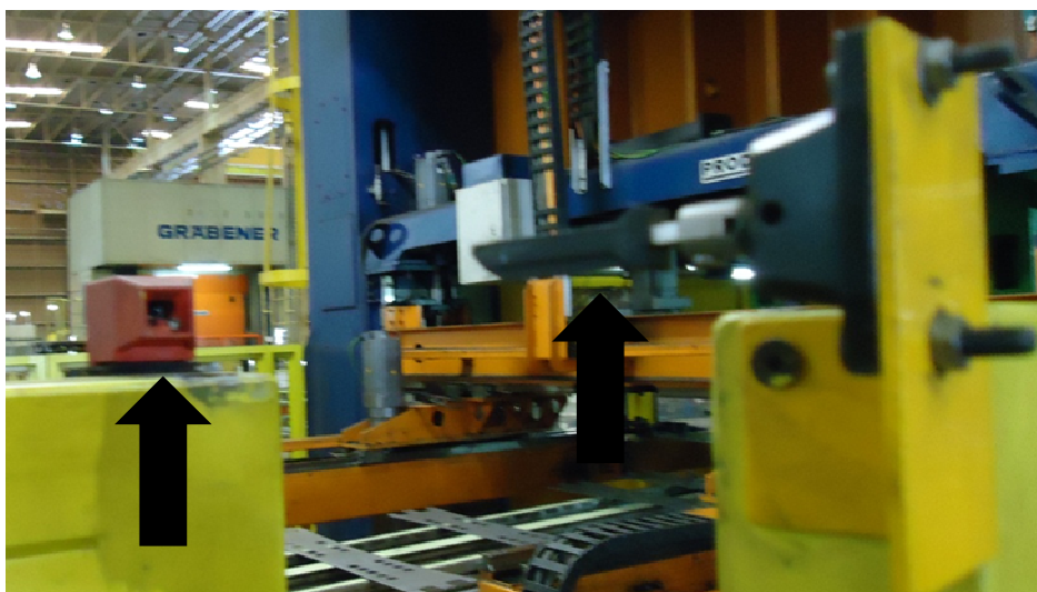
Figura 03 – Proteção Móvel – Chave Magnética– Prensa Weingarten – Fonte: PPRPS – Empresa XYZ
