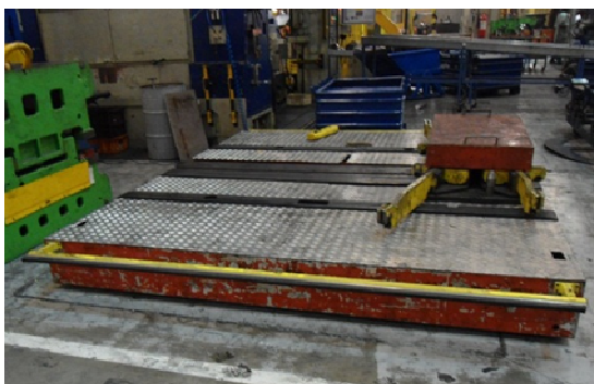
Figura 35 – Batente de Segurança instalado no carro transportador de ferramentas – Fonte: PPRPS da empresa XYZ
