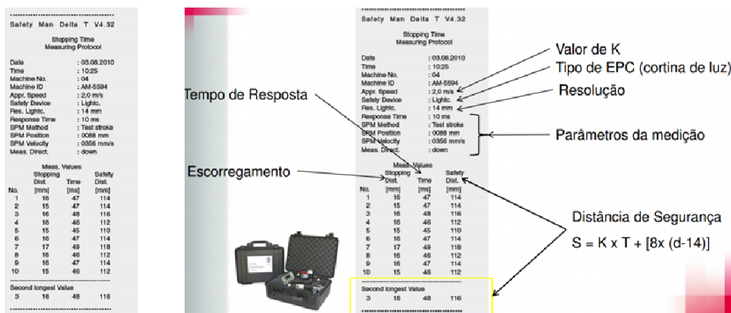
Figura 26 – Representação do teste de escorregamento para cálculos da distancia de segurança – Fonte: Catálogo Leuze Eletronic , 2012.
