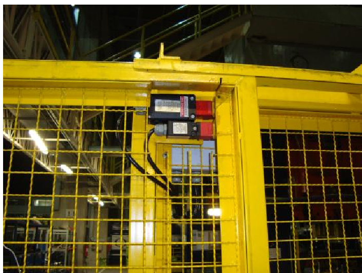
Figura 04 – Proteção Móvel – Chave Magnética – Prensa Weingarten – Fonte: PPRPS – Empresa XYZ
