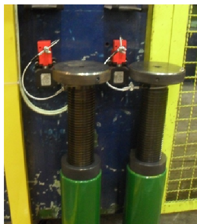
Figura 32 – Calços Mecânicos Fonte: PPRPS da empresa XYZ. Figura 33 – Calços Mecânicos interligados ao sistema de segurança – Fonte: PPRPS da empresa XYZ.
