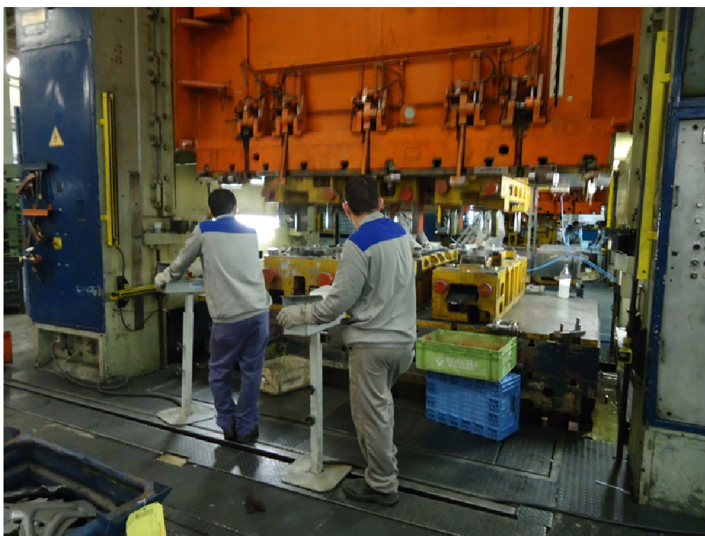
Figura 15 – Sistema Bi Manual sendo utilizado no processo de estampagem – Fonte: PPRPS empresa XYZ
