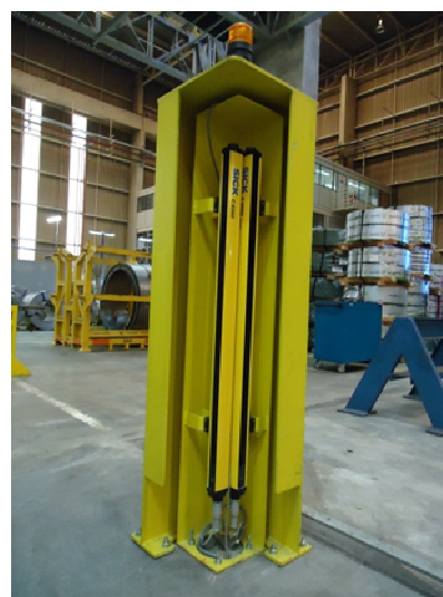
Figura 09 – Controle Perimetral para controle durante a troca de ferramentas – Colunas com barreiras duplas – Fonte: PPRPS empresa XYZ.
