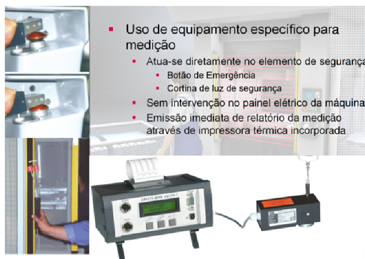
Figura 27 – Representação da medição do escorregamento do martelo para definição da distancia de segurança, através do dispositivo certificado mod. SAFETY MAN DELTA. Fonte: Catálogo Leuze Eletronic , 2012.
