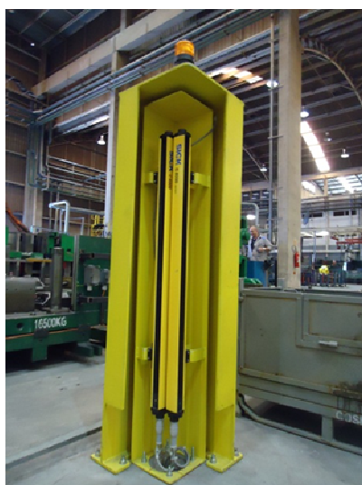
Figura 09 – Controle Perimetral para controle durante a troca de ferramentas – Colunas com barreiras duplas – Fonte: PPRPS empresa XYZ.
