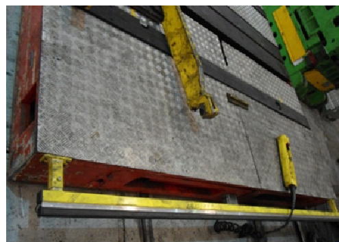
Figura 35 – Batente de Segurança instalado no carro transportador de ferramentas – Fonte: PPRPS da empresa XYZ
