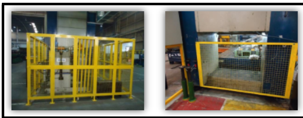
Figura 4 – Proteção fixa Fonte: Schmersal (2014).
