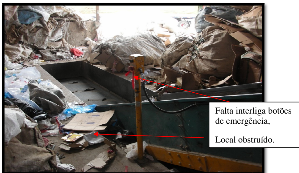
Figura 16 – Localização do botão de emergência.
