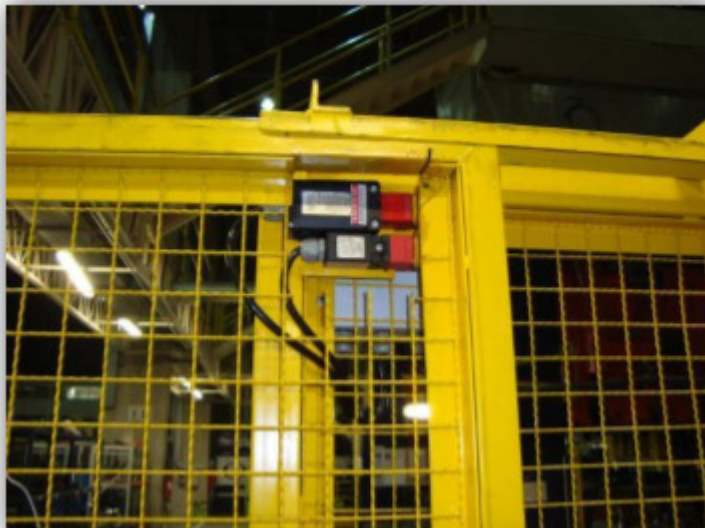
Figura 5 – Proteção móvel com chave magnética
