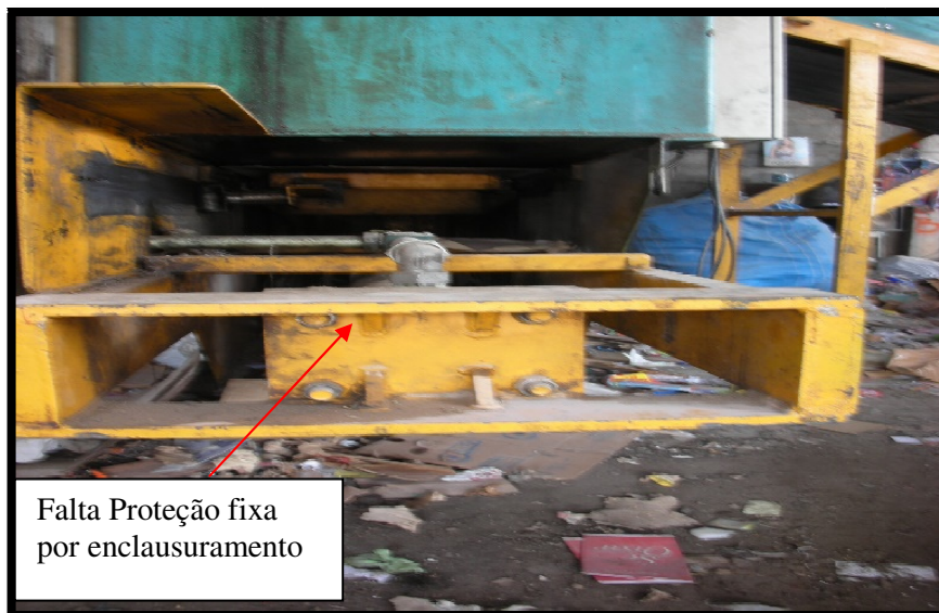
Figura 11 – Zona de Prensagem Fonte: Próprio Autor (2015).
