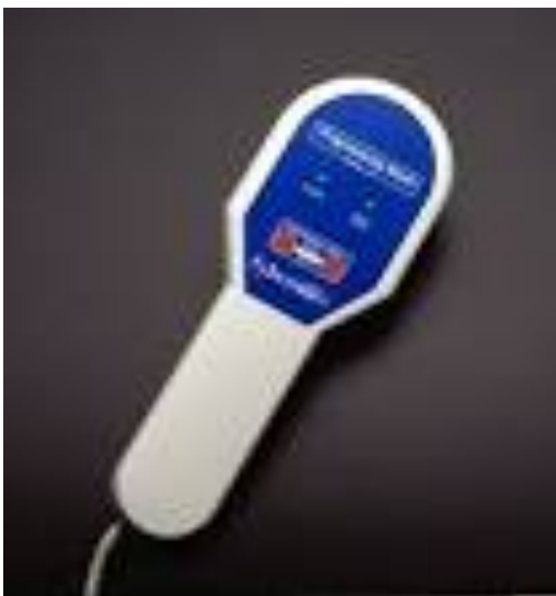
Figura 5: Ferramenta utilizada para ajuste dos parâmetros da estimulação elétrica vagal através de telemetria
