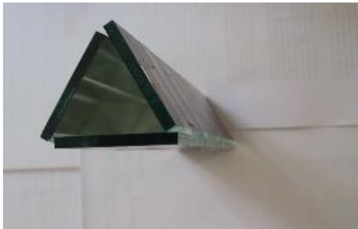
Figura 8 - Vista dos espelhos que fazem ângulo de 60^\circ para formação do caleidoscópio Fonte: Autoria própria
