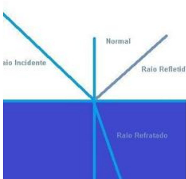
Figura 17 - Raio incidente, refratado, normal Fonte: Própria
