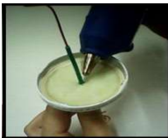
Figura 7 – Fixando o fio na tampa. Fonte: Acervo do pesquisador.
