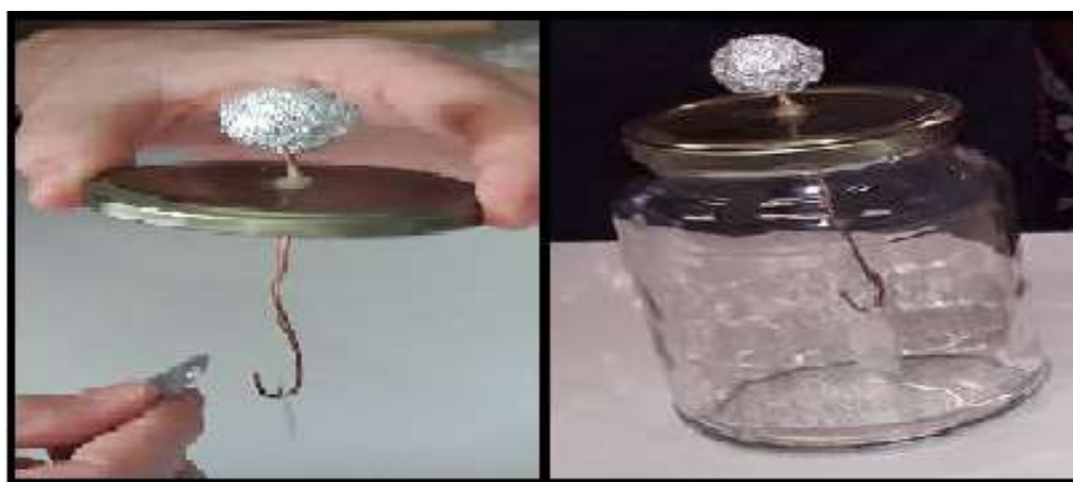
Figura 8 – Cortando as folhas de papel alumínio e finalizando o eletroscópio.
