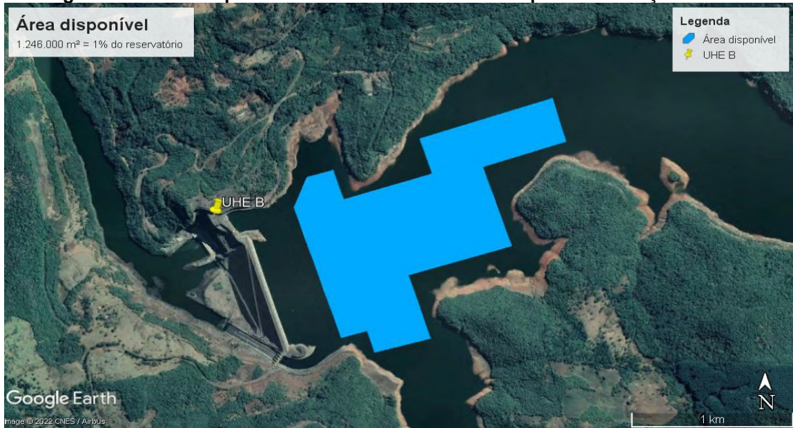
Figura 14 - Local disponível utilizando 1% da área total para a instalação da UFF.
