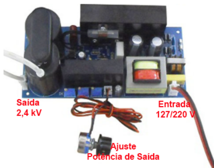
Figura 22 – Fonte de Alta Tensão
