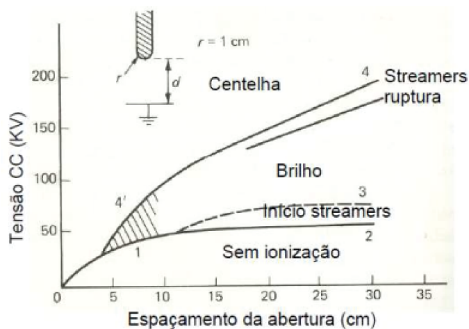
Figura 9 – Curvas limiaries da descarga corona positiva e da ruptura de centelhas na configuração ponta-plano
