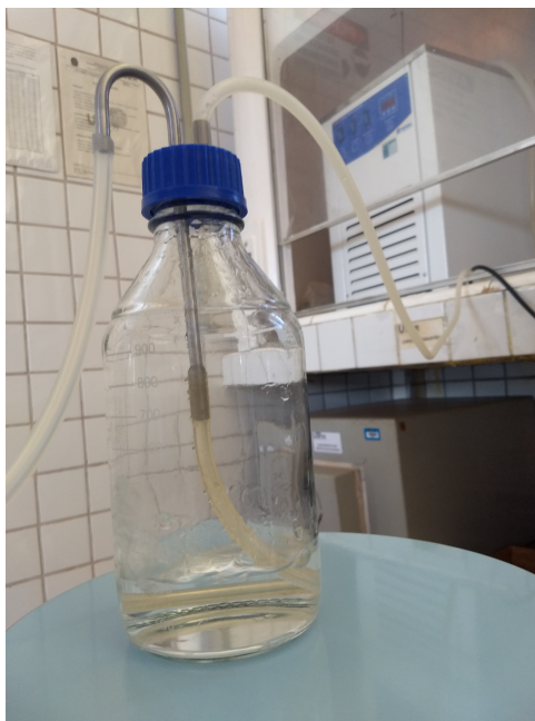
Figura 34 – Ozônio injetado no lavador de gases através do borbulhamento
