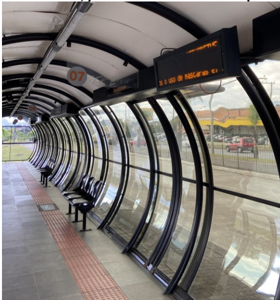
Fotografia 4 – Letreiro LED, portas automáticas e lâmpadas tubulares LED
