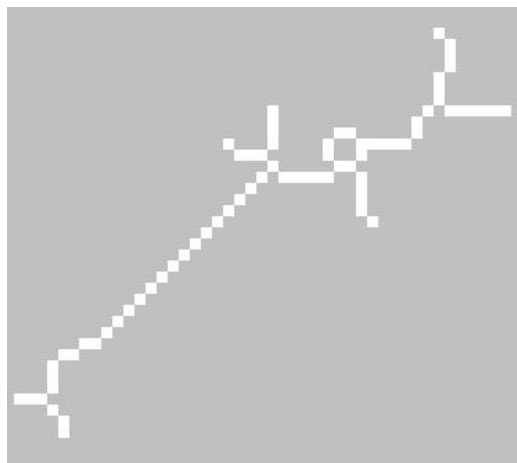
Figura 35: Resultado do algoritmo de eliminação de pixels redundantes . Nenhuma lacuna está presente no esqueleto da estrutura resultante – não há quebra de conexão.
