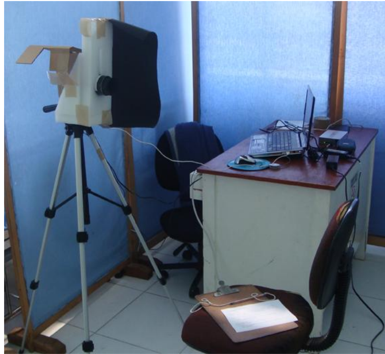
Figura 50: Sistema de Captura – aparato utilizado para aquisição das imagens dos voluntários.
