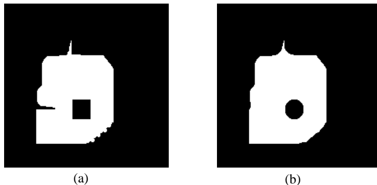
Figura 67: Fechamento (imagem binária): (a) imagem original e (b) imagem após o fechamento .
