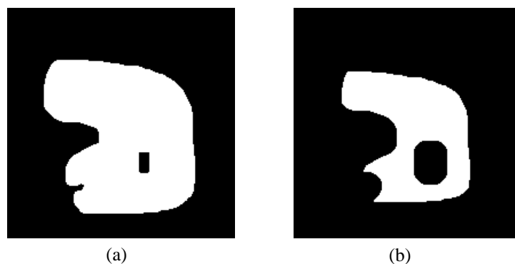
Figura 61: Erosão (imagem binária): (a) imagem original e (b) imagem após a erosão .
