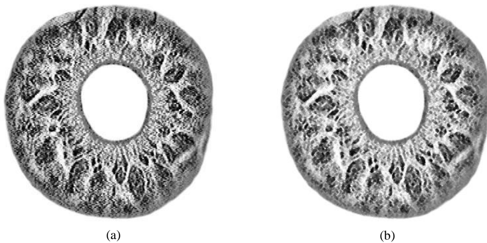
Figura 69: Exemplo do efeito do fechamento em tons de cinza: (a) imagem original e (b) imagem após o fechamento .
