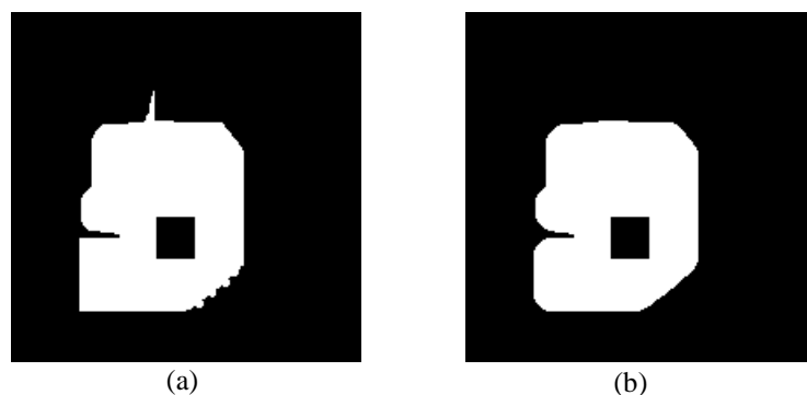
Figura 64: Abertura (imagem binária): (a) imagem original e (b) imagem após a abertura .
