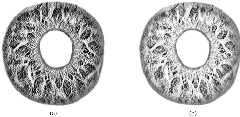
Figura 60: Exemplo do efeito da dilatação em tons de cinza: (a) imagem original e (b) imagem após a dilatação .
