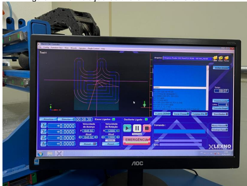
Figura 11 - Simulação Software Mach3 CNC Controller
