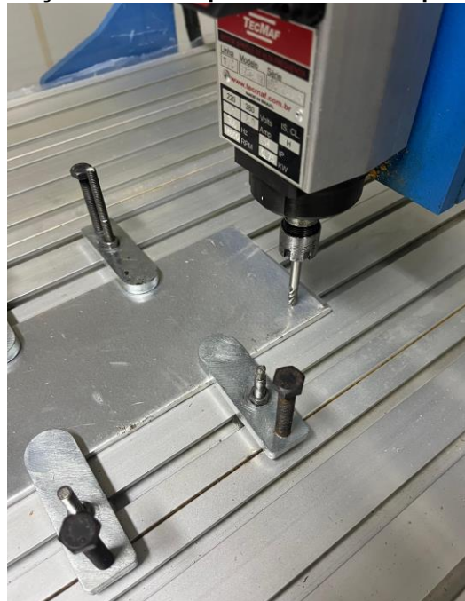
Figura 6 – Instalação da fresa topo e zeramento da primeira usinagem
