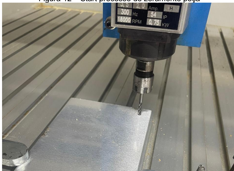
Figura 12 – Start processo de zeramento peça
