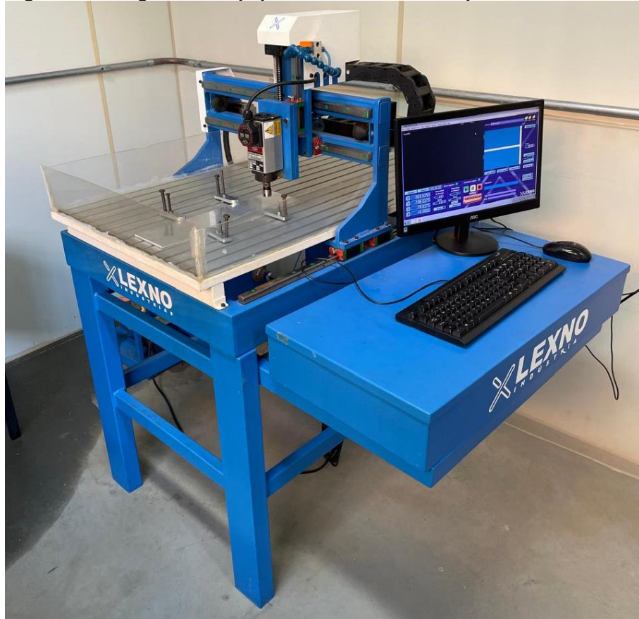
Figura 3 - Fotografia do equipamento CNC Router spindle TVS.12M3.12
