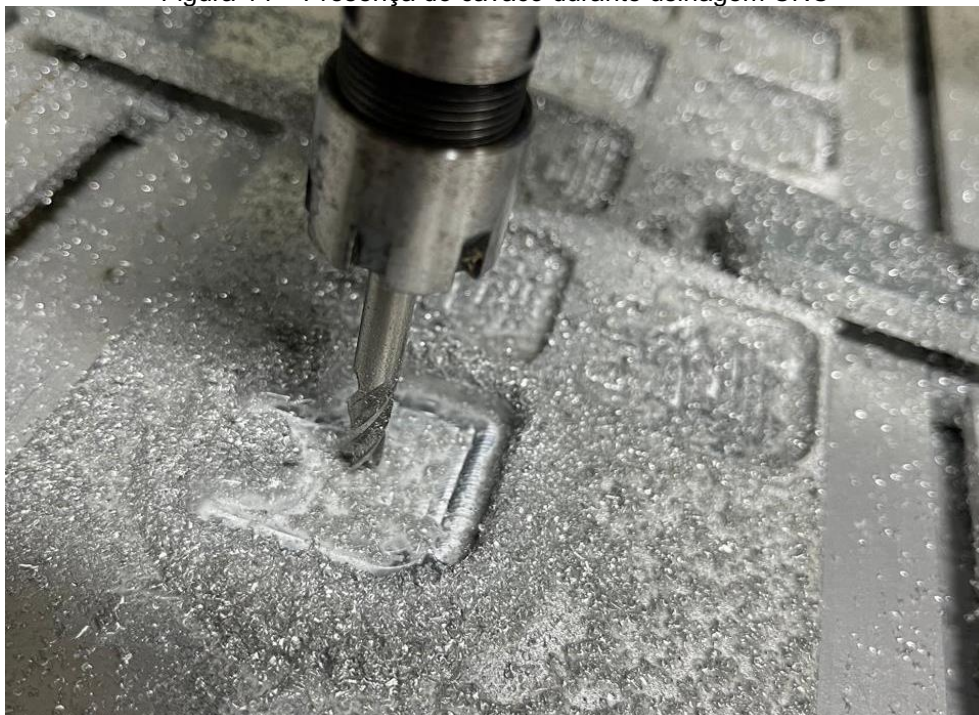
Figura 14 – Presença do cavaco durante usinagem CNC
