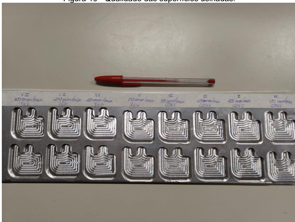
Figura 10 - Qualidade das superfícies usinadas.
