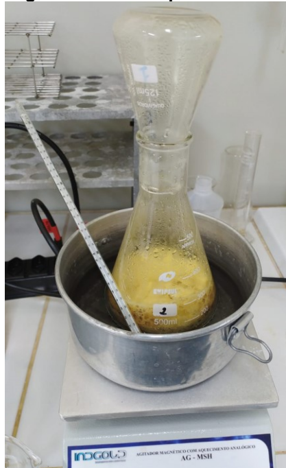
Figura 8 – Montagem do sistema para análise de holocelulose
