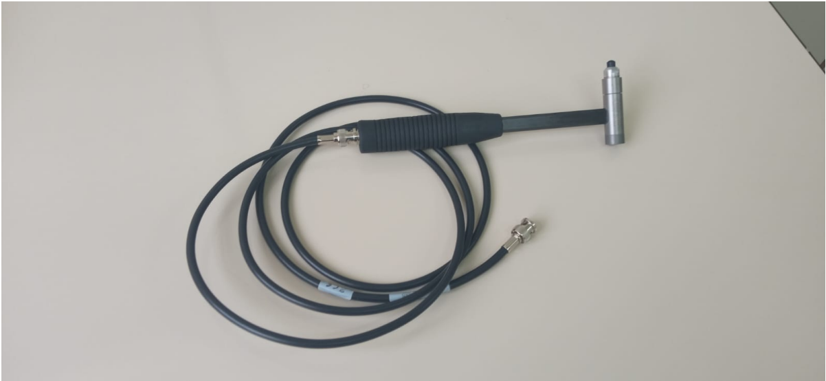
Figura 9 – Martelo de impacto PCB Piezotronics modelo 086C03 utilizado no estudo
