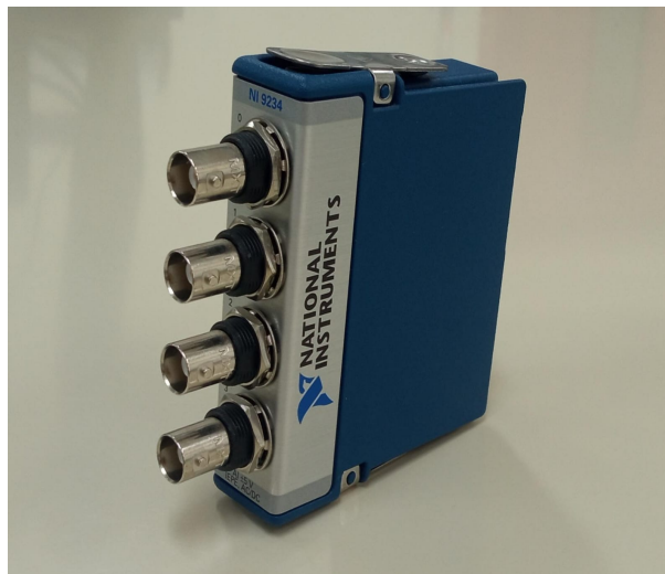
Figura 8 – Módulo de aquisição de sinais NI9234 da National Instruments
