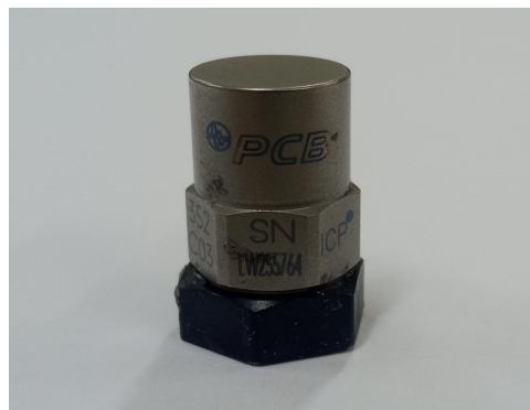
Figura 7 – Acelerômetro PCB Piezotronics modelo 352C03 utilizado no estudo
