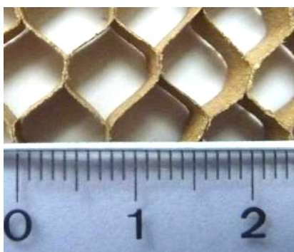
Figura 2.14 - Núcleo hexagonal em Testliner com células de 7 mm.
