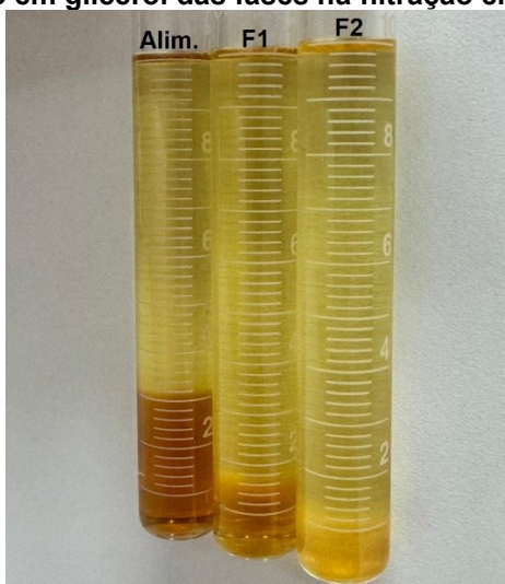
Fotografia 6 – Composição em glicerol das fases na filtração em série da mistura reacional
