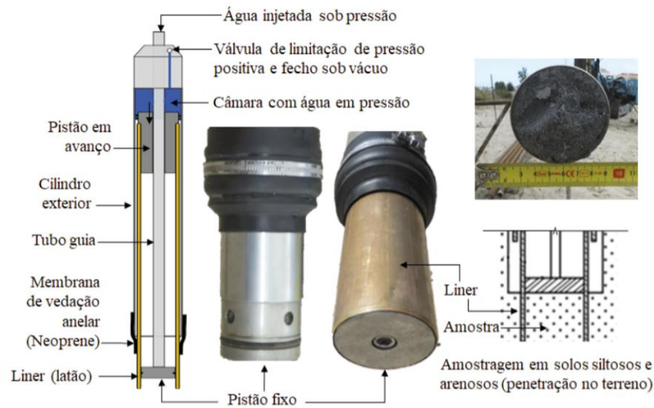
Figura 11 – Componentes do amostrador D&M.
