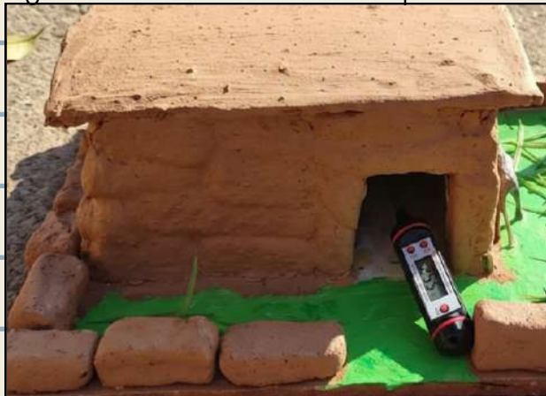
Figura 18 - Mini casa de barro exposta ao sol
