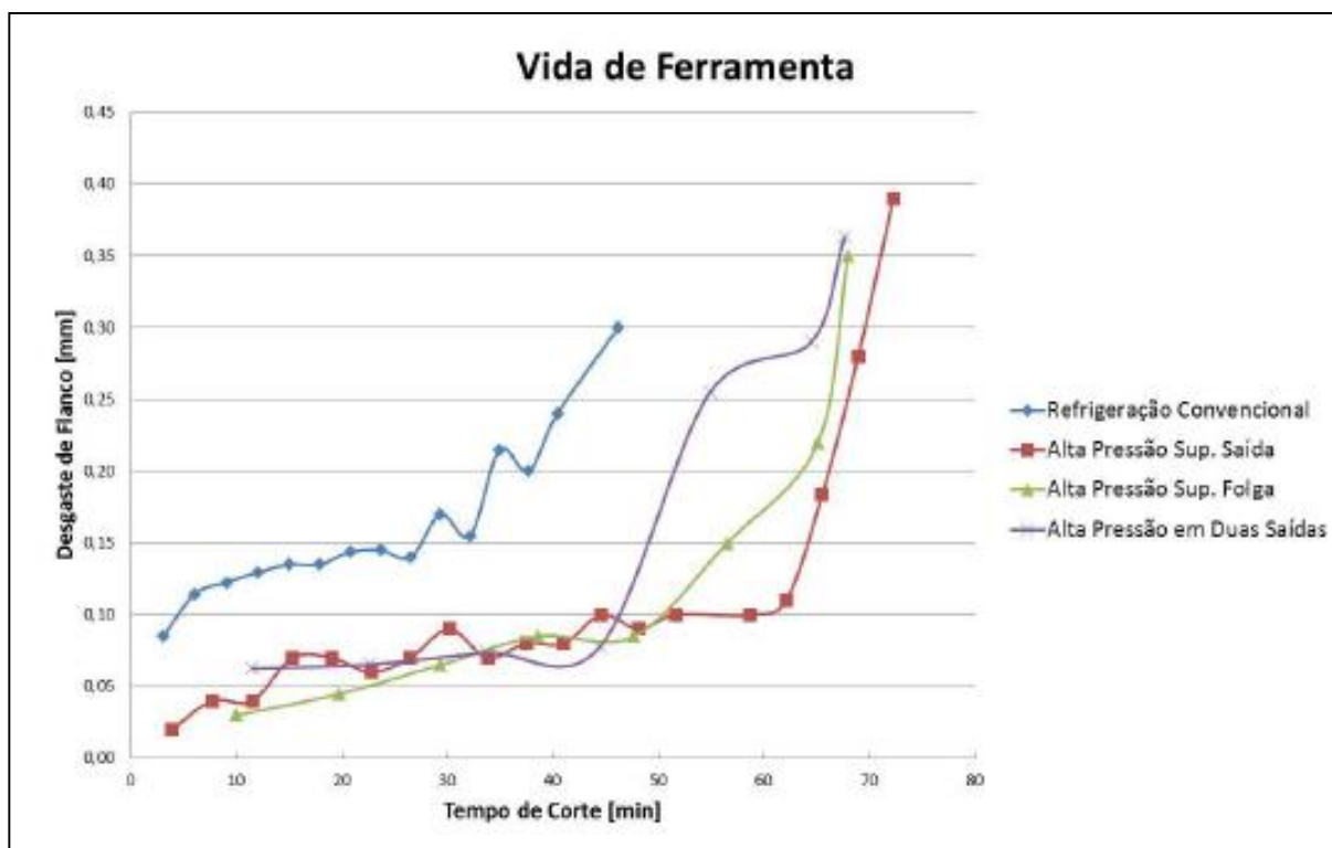
Gráfico 11 – Comportamento do desgaste de flanco ao longo do tempo para diferentes condições de refrigeração
