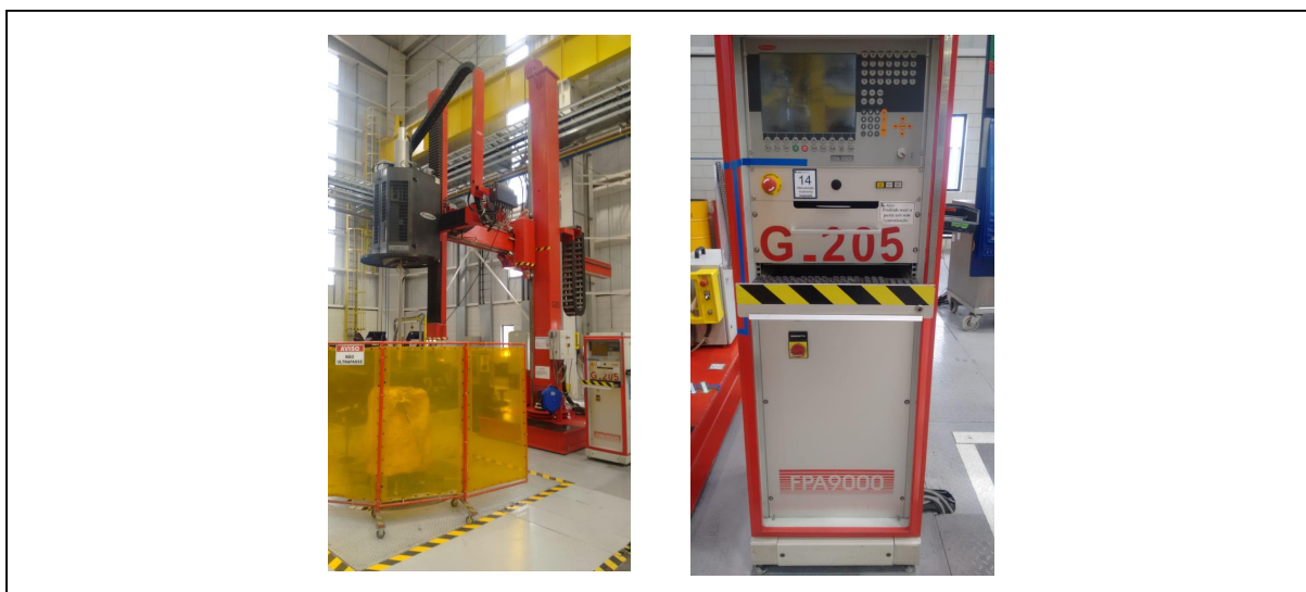
Figura 35 – Fronius FPA 9000 Utilizada para revestimento dos corpos de prova
