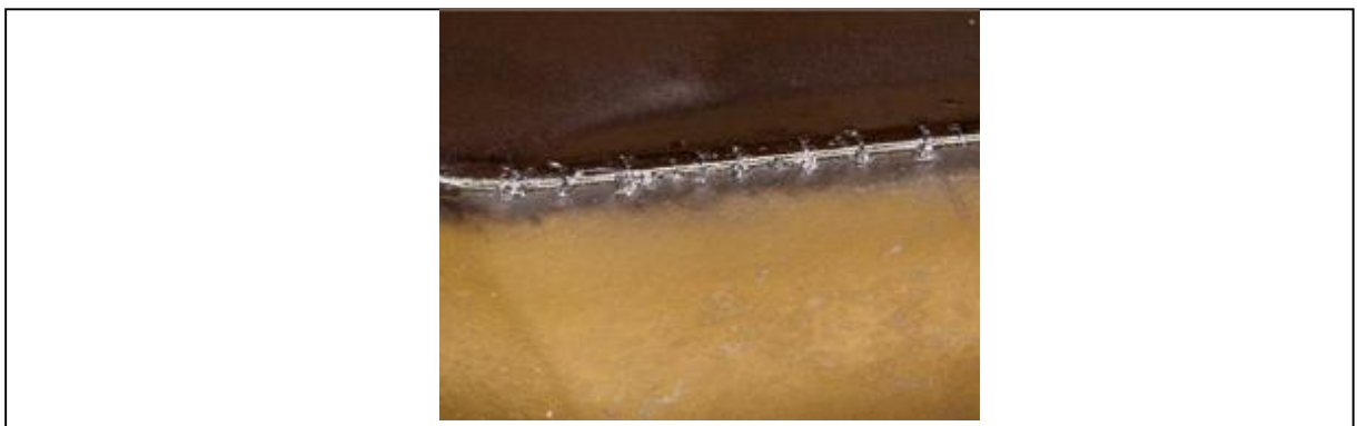
Figura 17 – Trincas perpendiculares à aresta de corte
