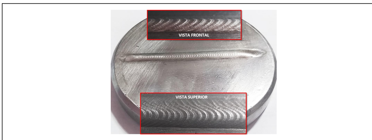
Figura 40 – Corpo de prova com cordão de revestimento depositado na posição plana
