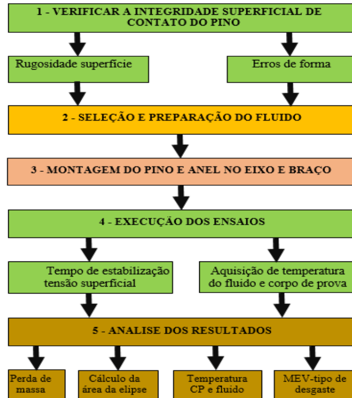
Figura 28 - Sequência de Ensaio Tribológico de Reichert Test .
