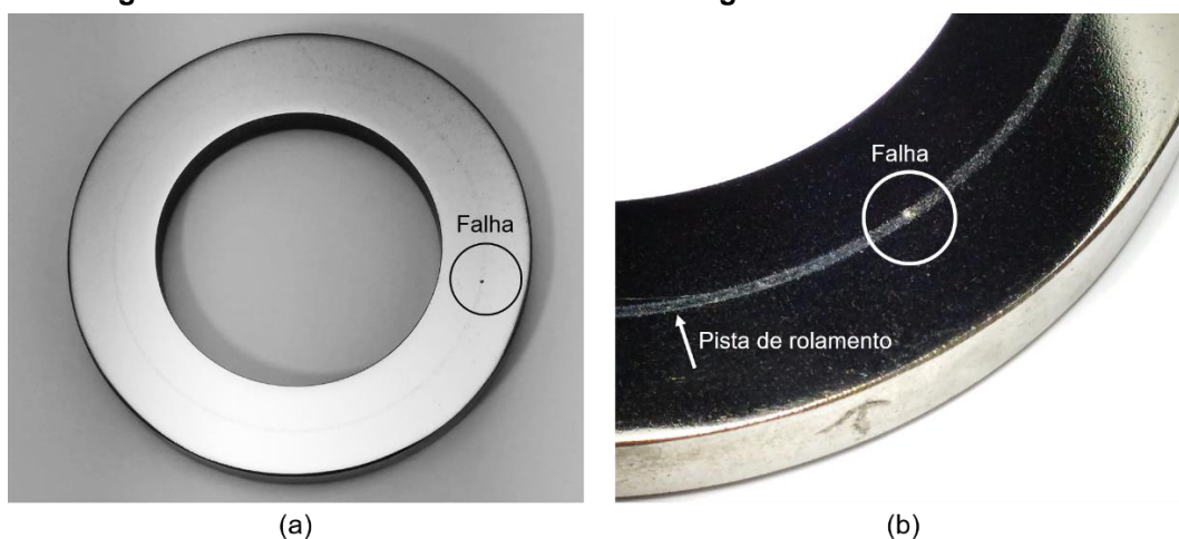
Figura 56. Falha resultante do ensaio de fadiga de contato de rolamento
