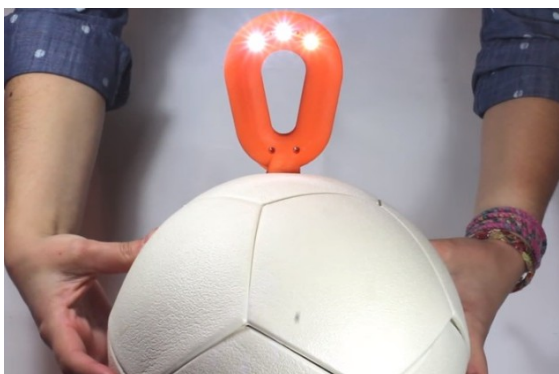
Figura 4.1: Bola de futebol que armazena energia elétrica através de energia cinética
