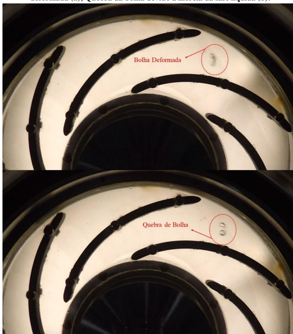
Figura 6.17 – Quebra de bolha ao longo de sua trajetória devido a inércia da fase líquida: Bolha deformada (a); Quebra da bolha devido a inércia da fase líquida (b).
