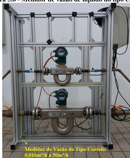
Figura 3.6 - Medidor de vazão de líquido do tipo Coriolis .
