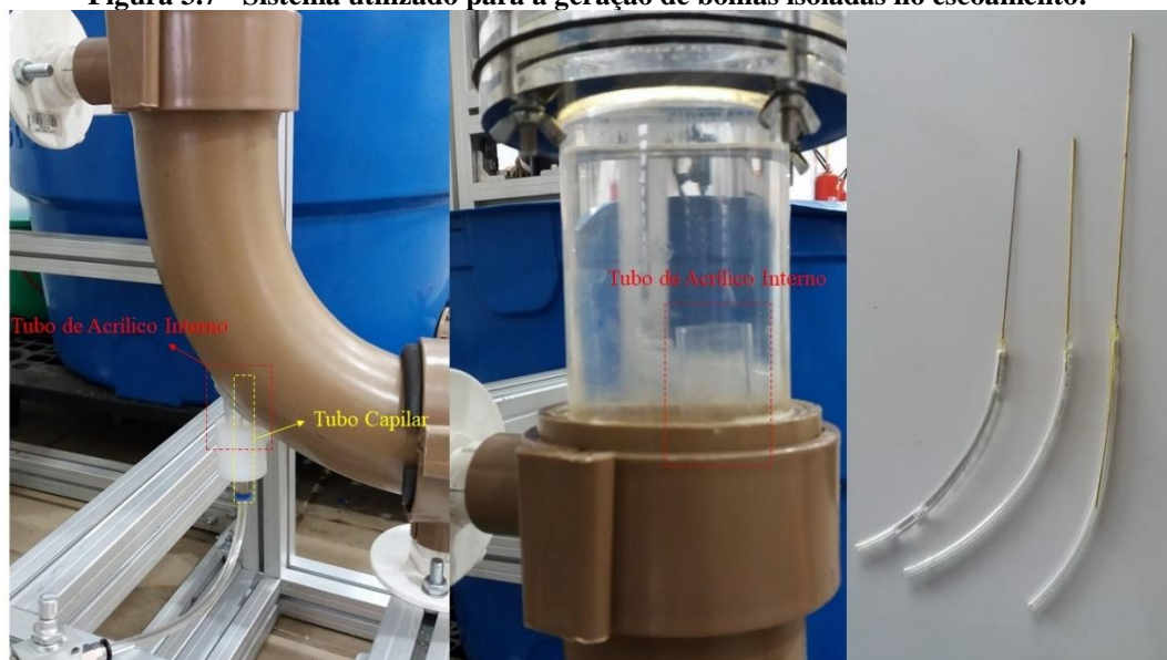
Figura 3.7 - Sistema utilizado para a geração de bolhas isoladas no escoamento.
