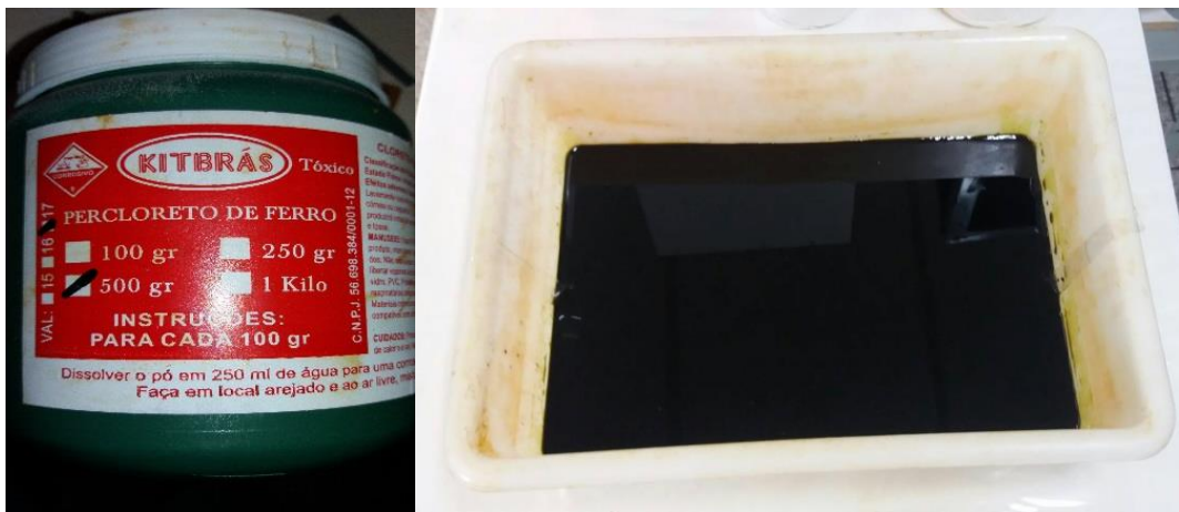
Figura 23: Produto utilizado no processo de corrosão.
