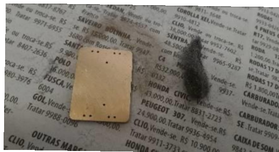
Figura 21. Limpeza da face cobreada.
