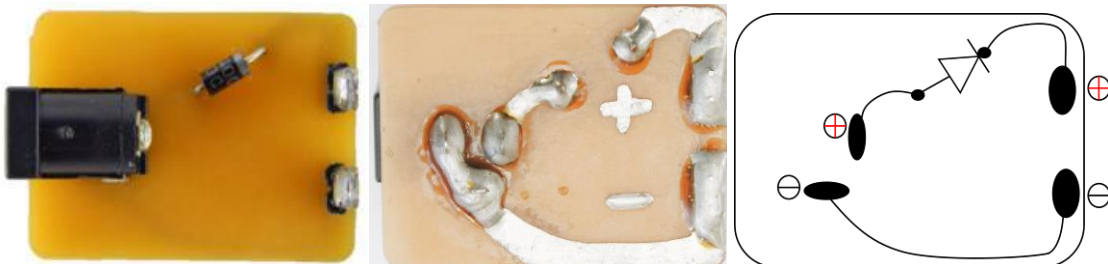
Figura 2: Módulo Energia, visão superior, inferior e do circuito, respectivamente.
