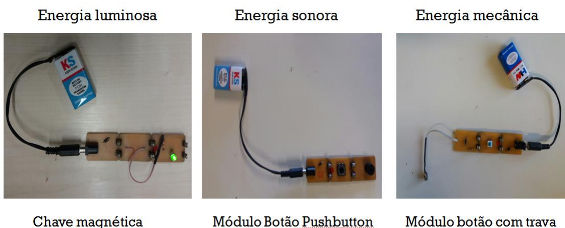
Figura 32: Uso de módulos do SimpleBits para o ensino de conversão de energia, em cada foto é utilizado um interruptor diferente.
