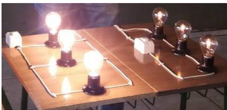
Figura 35: Conjunto demonstrativo de associação de resistores.
