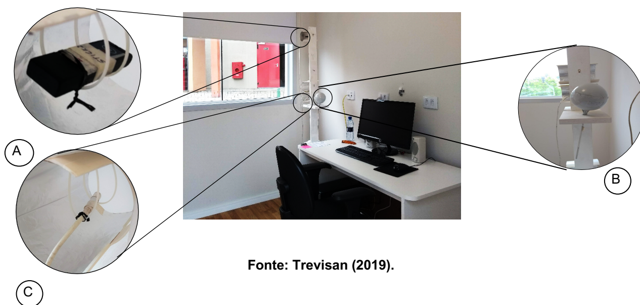
Figura 12 – Interior dos módulos na campanha INV: (A) Sensor TagTemp Stick; (B) Termômetro de Globo; (C) Sensor Temp U10-001.
